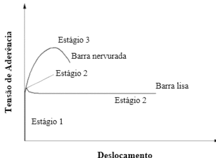
Figura 2.18 - Estágios de aderência aço-concreto. Fonte: Adaptado de FIB (1999).
