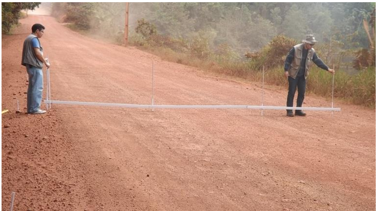
Fotografia 4: M.I.T disposto para a mensuração dos defeitos na rodovia Fonte: Pesquisa de campo
