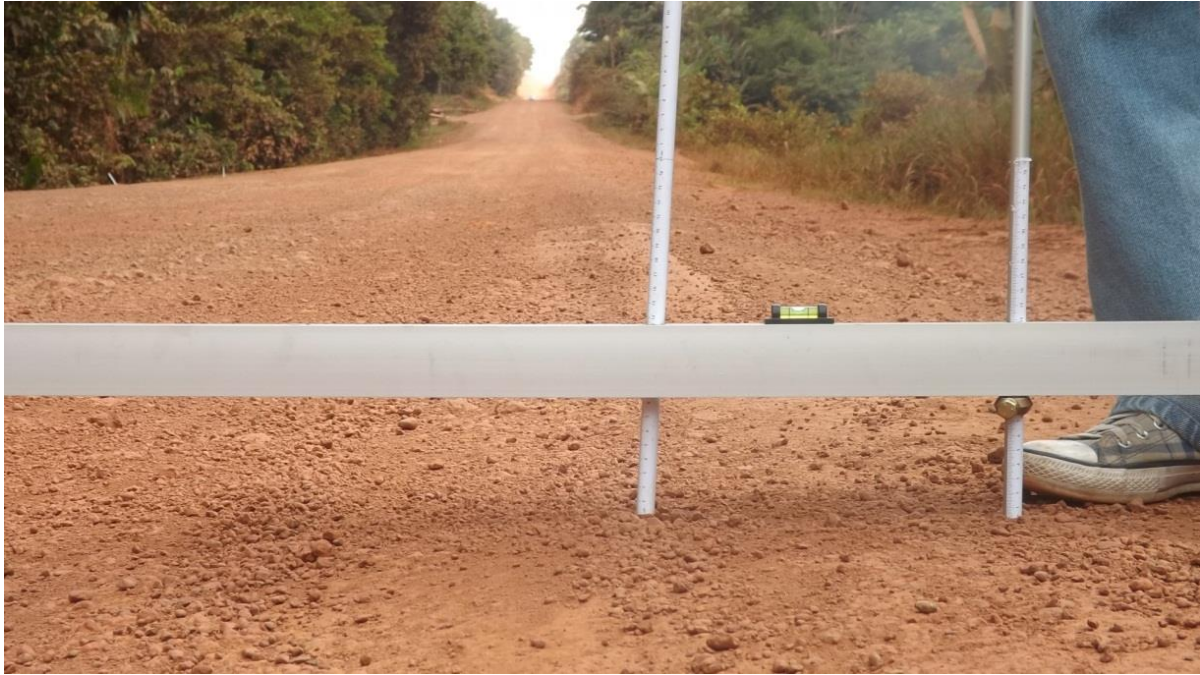
Fotografia 6: Régua móvel disposta para medição das profundidades dos defeitos no terrapleno da via. Fonte: Pesquisa de campo
