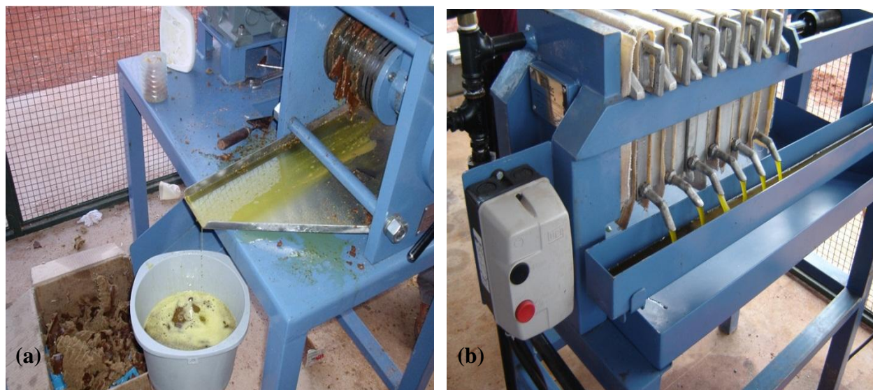
Figura 3. Extração de óleo de sementes ou frutos por prensagem em prensa contínua (a) e filtragem do óleo obtido em filtro-prensa (b).
