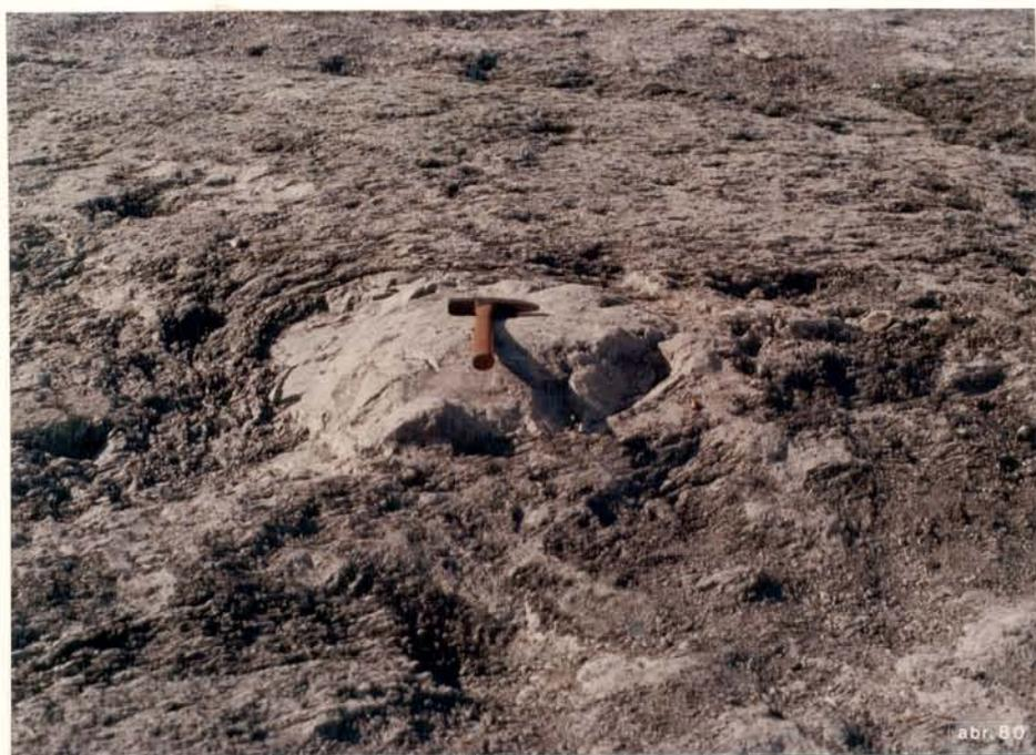
FIG. 13 - Detalhe das rochas cataclásticas de origem máfica, associadas ao falhamento de empurrão, no canal central da barragem.
