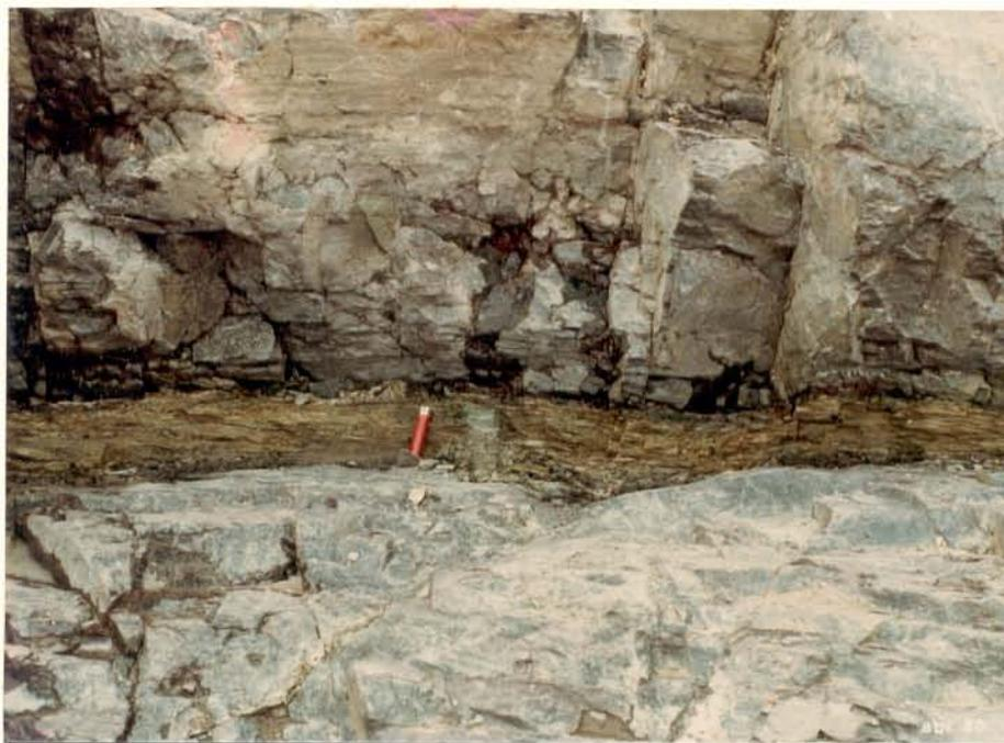
FIG. 43 - Grauvacas da Formação Morrote no canal central da barragem. Zona epidotizada e silicificada subhorizontal, com família de juntas verticais.
