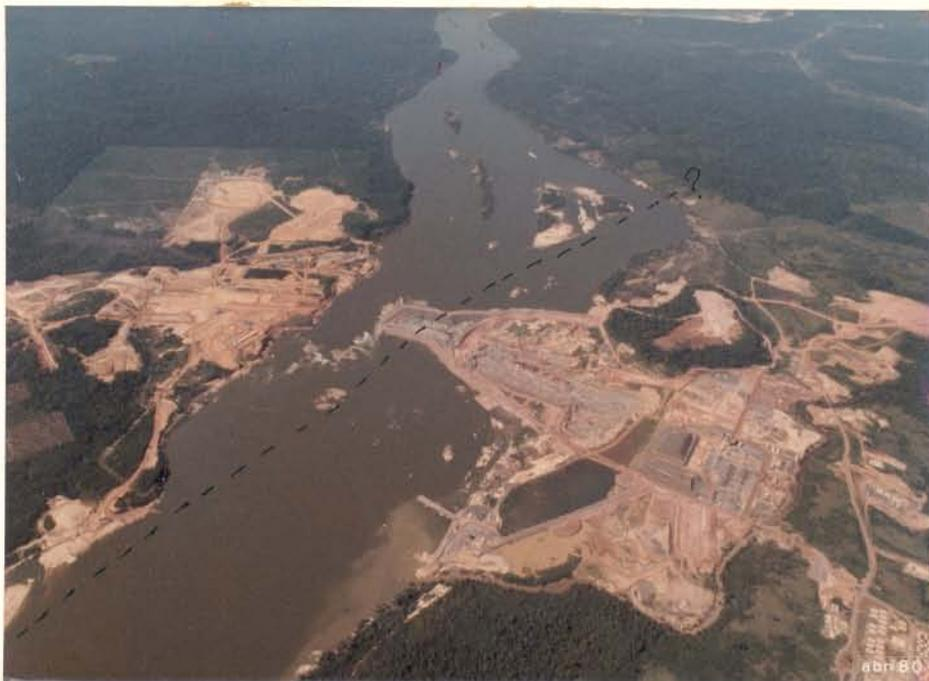
FIG. 1 - Vista aérea do eixo da barragem de Tucuruí em Abril/80. Nota-se o desvio do rio Tocantins, com a largura de seu leito reduzida; algumas ilhas que foram investigadas; e o canteiro de obras. A linha tracejada mostra o traço aproximado da falha de Tucuruí.
