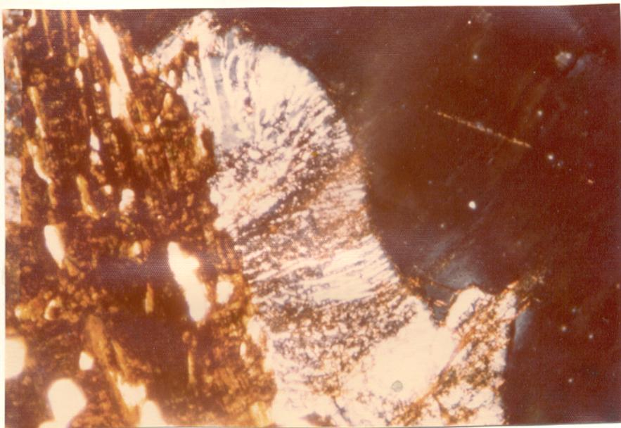
Fotomicrografia 5 - Intercrescimento de quartzo vermicular em plagioclásio. Nicóis cruzados. Ampliação 200 x.
