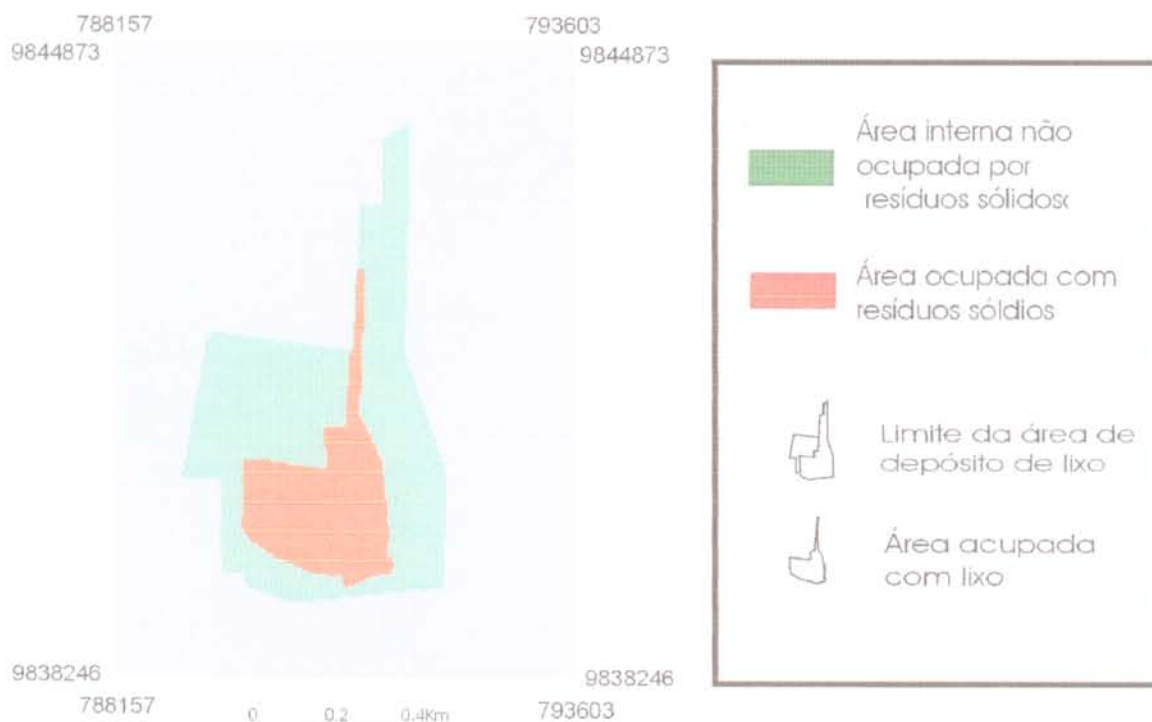
Figura 6.9- Distribuição espacial da área ocupada com resíduos sólidos e lagos de chorume em relação à área interna do depósito de resíduos sólidos.
