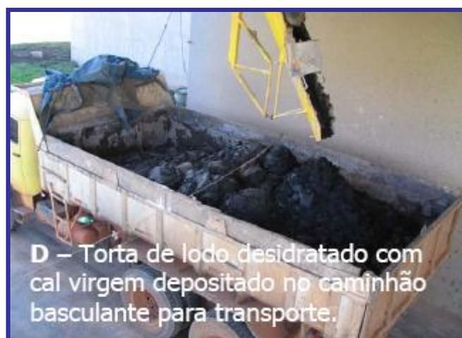
Fotografia 2 – Caminhão basculante com lodo
