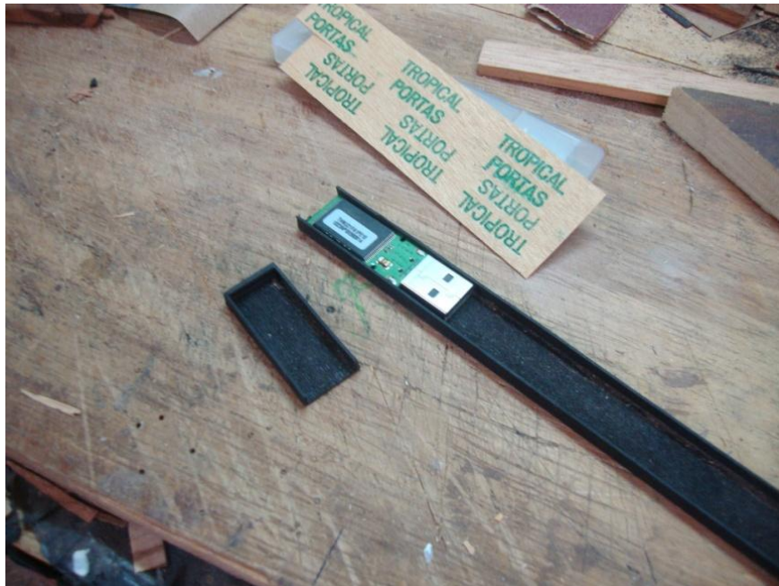
Figura 54 - Caneleta do pen drive em madeira, teste de largura, 2010. Fonte: Arquivo pessoal
