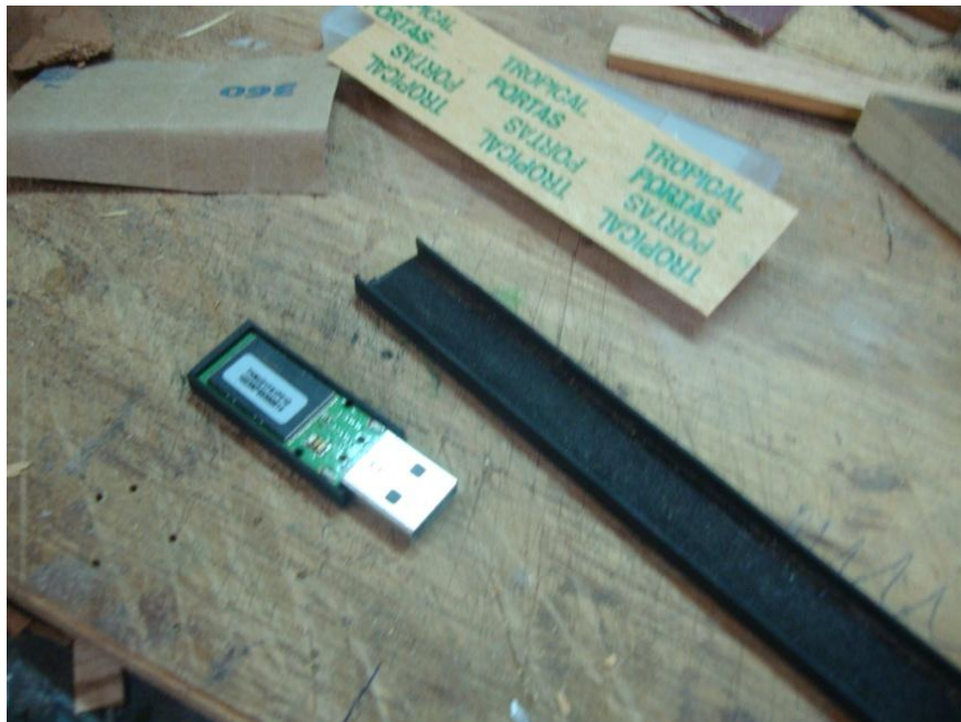
Figura 55 - Corpo do pen drive já colocado na canaleta de madeira, 2010. Fonte: Arquivo pessoal.
