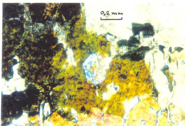
Figura 4.23 - Epídoto idiomórfico incluso em biotita (no centro da foto). Este tipo é similar ao tipo-3 de SIAL (1990). (Granitóide Tourão).
