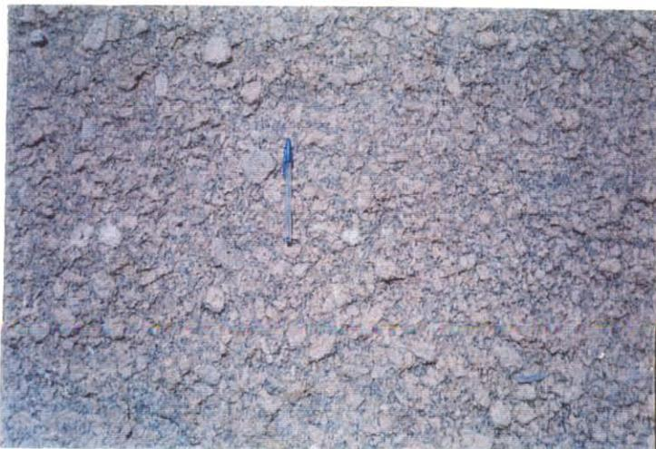
Figura 3.14 - Textura porfirítica da Fácies Tourão do granitóide homônimo (Af 224 próximo ao paredão do Açude Tourão a N da cidade de Patu).
