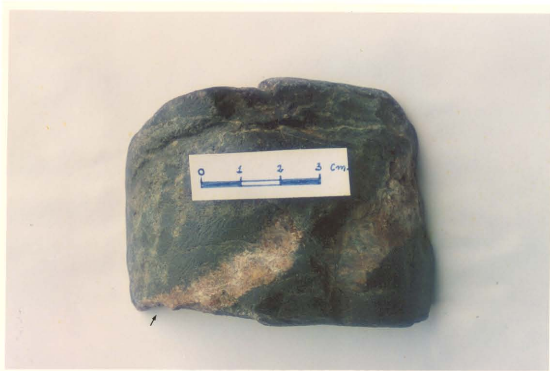
Fig.29. Milonito do embasamento da Bacia de Bragança-Viseu testemunhado (1.100 m) no poço VN-1-ST da Petrobrás apresentando as mesmas características dos xistos grafitosos descritos no Grupo Gurupi (Oliveira, 1977) ao longo da Zona de Cisalhamento Tentugal. Observar um veio granítico róseo (seta) discordante da foliação milonítica do milonito cinza-escuro.
