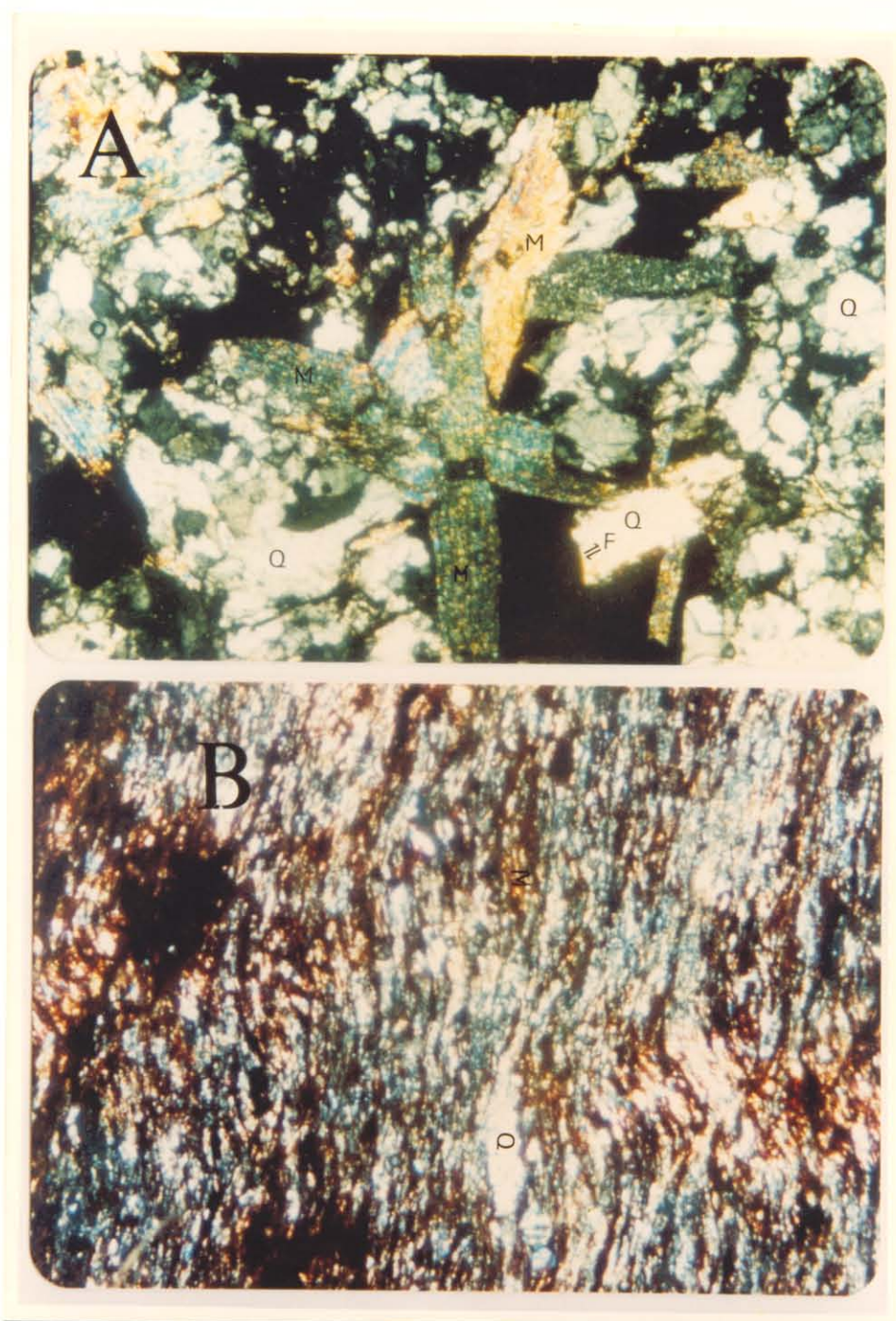
Fig.30. Detalhe ao microscópio da amostra da figura anterior (Fig. 29). Trata-se de um sericita-milonito com forte lenticularização e anastomosamento da foliação milonítica apresentando "pods" elipsoidais característicos de um sistema direcional (Gurupi?). (A)- Aspectos texturais dos "pods"; (B)- Anastomose milonítica; M- Micas; Q- Quartzo; F- Minerais opacos ferruginosos.
