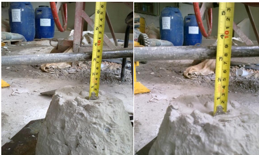
Figura 3.2 – Determinação de abatimento de tronco de cone (slump test).
