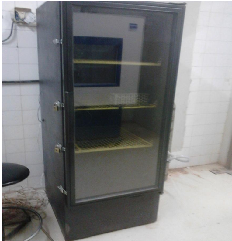
3.11- Imagem da câmara de carbonatação utilizada nos ensaios.
