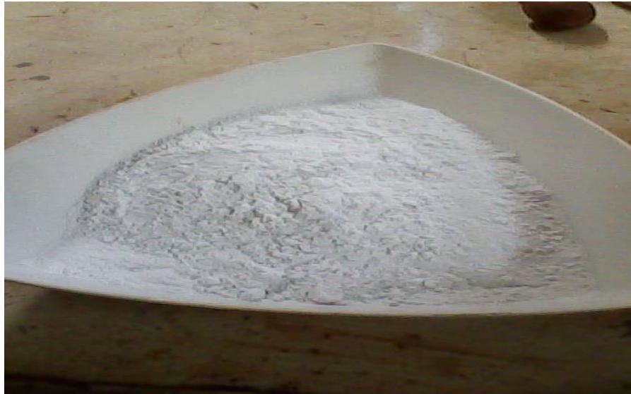
Figura 2.11 – Aparência do cimento portland branco utilizado na pesquisa (autoria própria).
