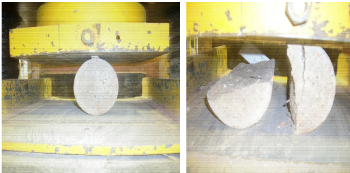
Figura 3.5 – Ensaio de tração por compressão diametral – Ruptura por fendilhamento. Módulo Estático de Elasticidade à Compressão do Concreto.
