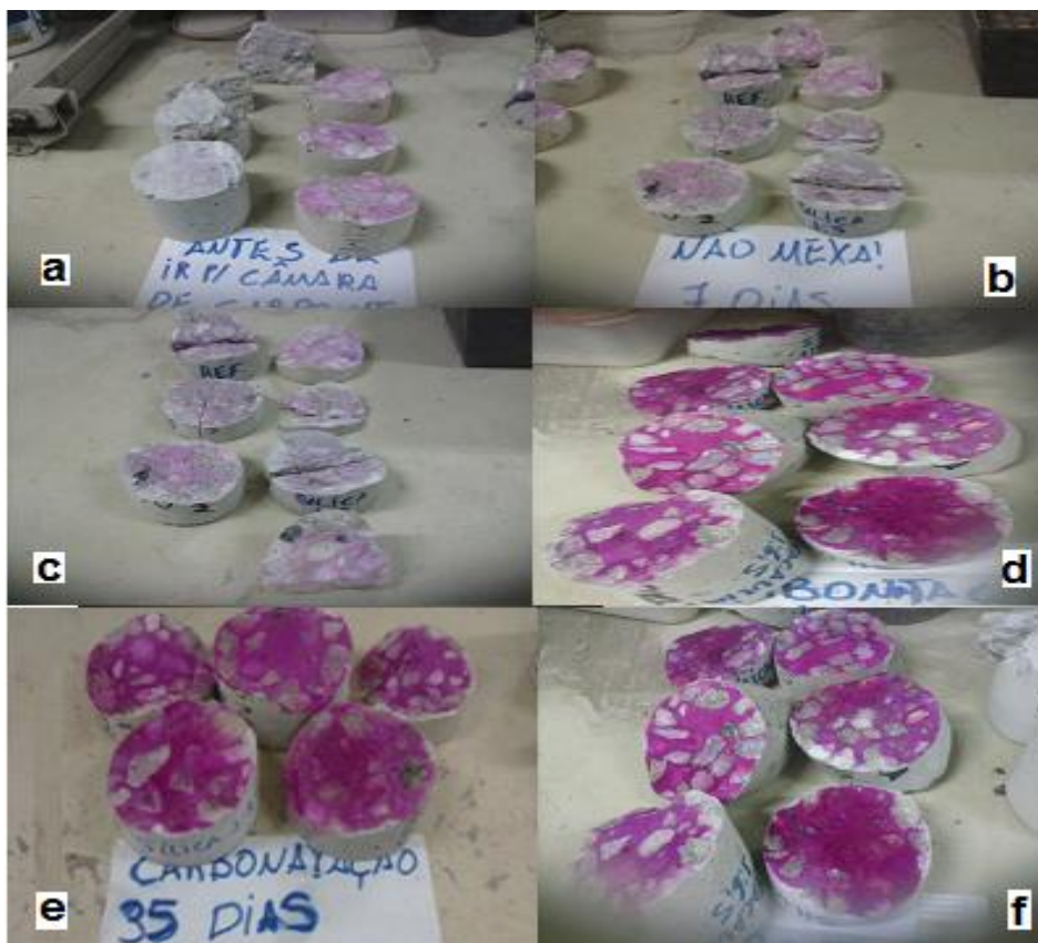
Figura 4.27- Aparência dos corpos-de-prova após o ensaio de carbonatação acelerada, (a) antes de entrar na câmara, (b) 7 dias, (c) 14 dias, (d) 28 dias, (e) 35 dias e (f) 42 dias respectivamente.
