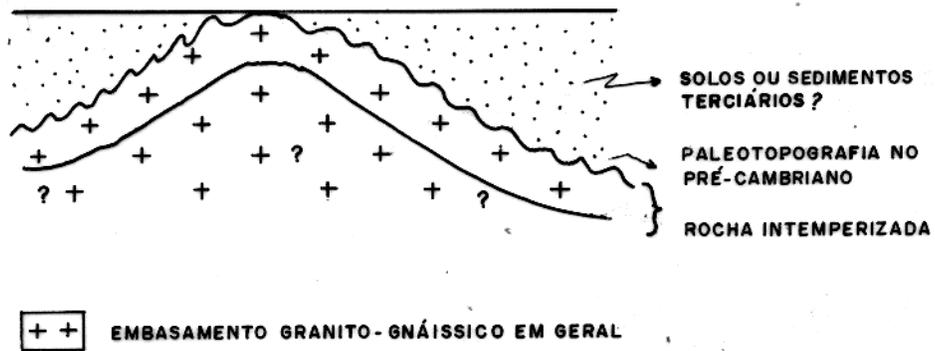
FIG.11- UM MODELO GEOLÓGICO DA SUBSUPERFÍCIE PROPOSTO PARA JUSTIFICAR A FEIÇÃO DAS SEV OBTIDAS NA REGIÃO DO "GRANITO".
