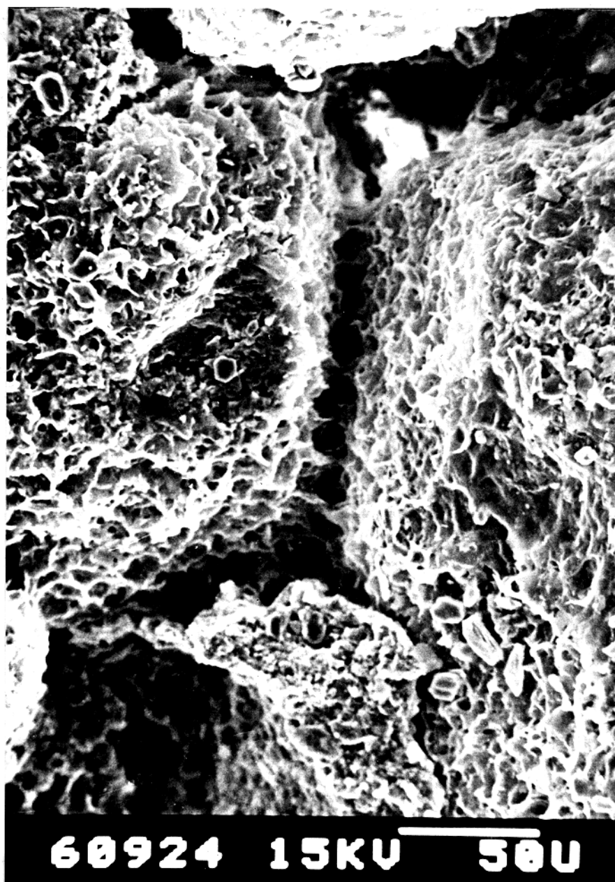
Figura 6 - Grãos recobertos com argila do tipo illita-esmectita formando "pontes". Notar a presença de lamelas de caulinita associada. Zona G do poço 7-UB-47-RNS ; 2501,2 m ( Pimentel & Cordeiro, 1984 ).
