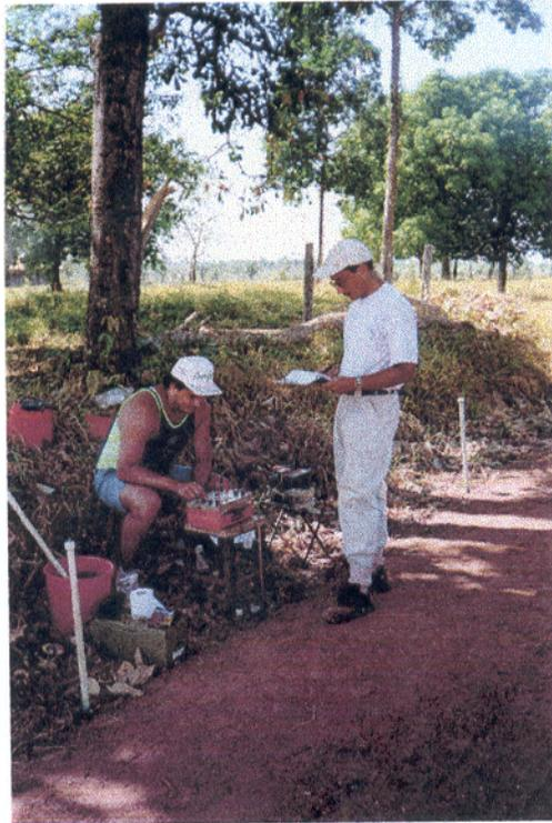
Figura 3.2 Resistivimetro, equipamento utilizado para as medidas de campo
