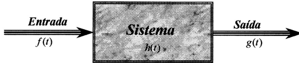
**Figura 2.2-** Diagrama de blocos do modelo convolucional simples e sem ruído.
