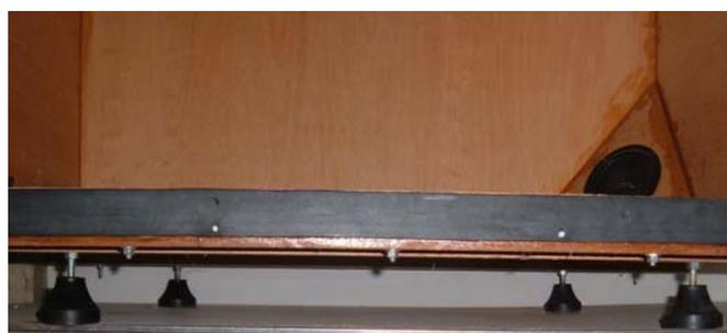
Figura 4.7 – Mini-Câmara com os Isoladores Instalados.
