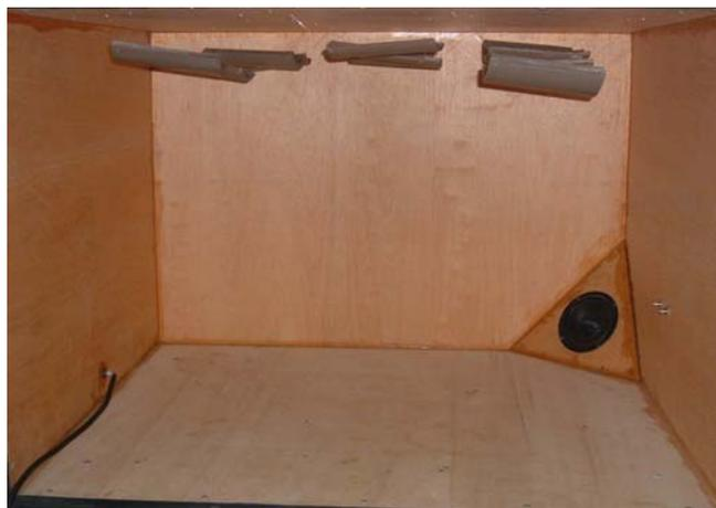
Figura 5.4 – Difusores estáticos instalados.
