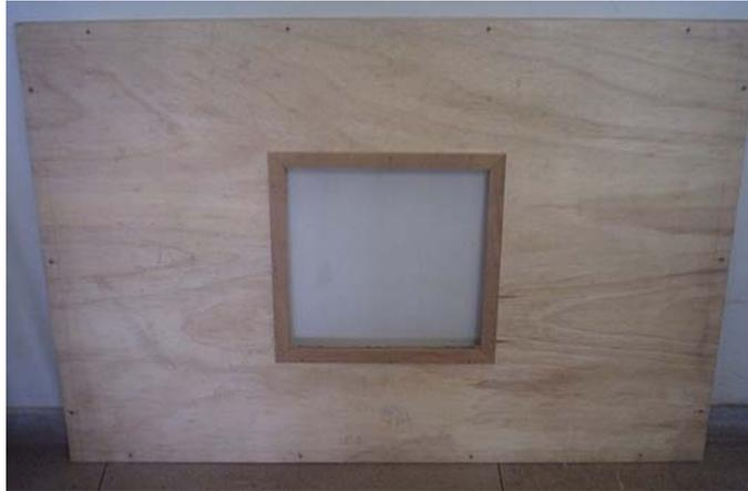
*Figura 4.4 – Parede Frontal com a Janela de Visualização Montada.*
