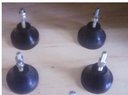
Figura 4.6 – Isoladores de Vibração Linha Micro, tipo Micro II.
