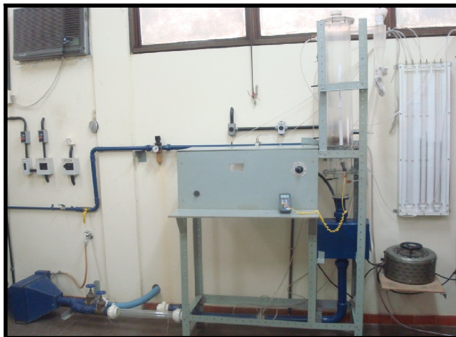
Fotografia 4. Secador de leito fluidizado utilizado neste trabalho
