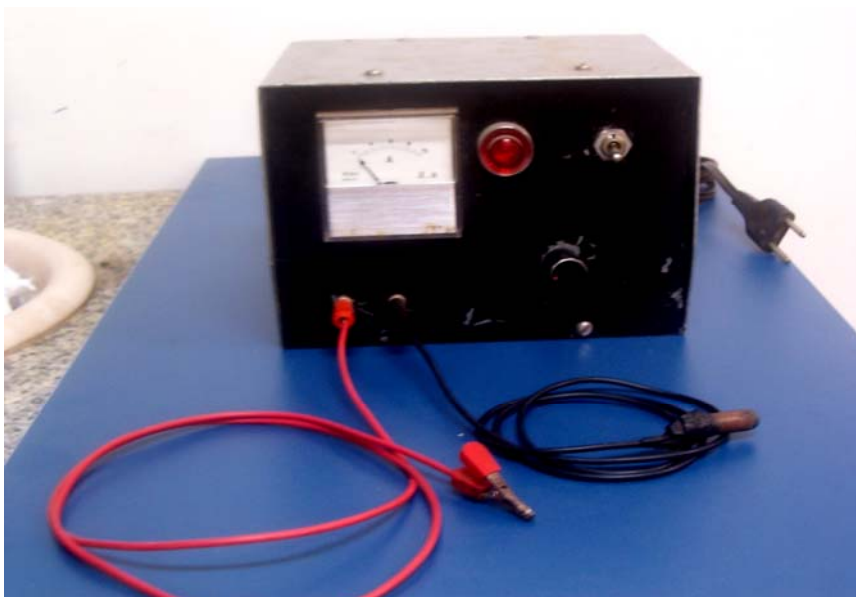
Figura 7-7. Máquina de confecção de termopares.
