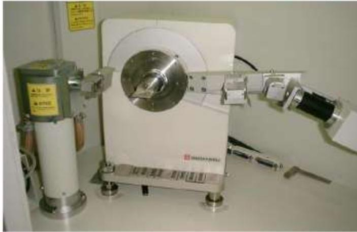
Fotografia 3.5: Equipamento de difração de raios X
