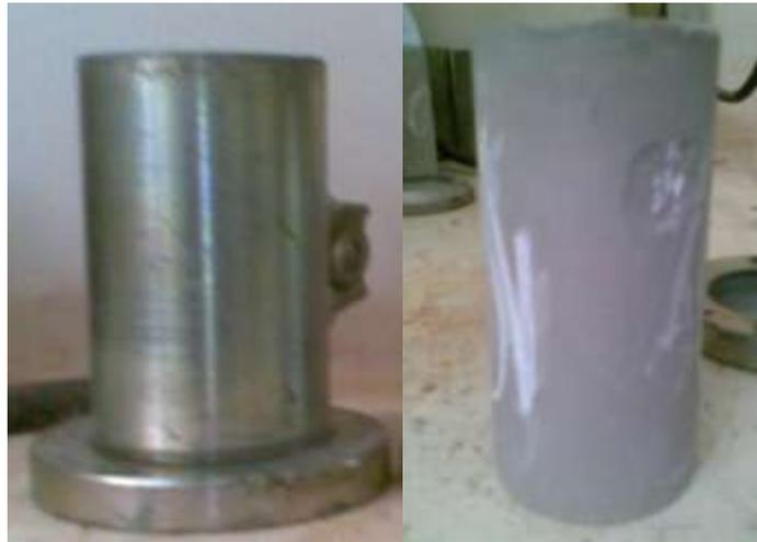
Fotografia 3.3: a) Moldes de tamanho 50 mm x 100 mm b) Corpos de prova
