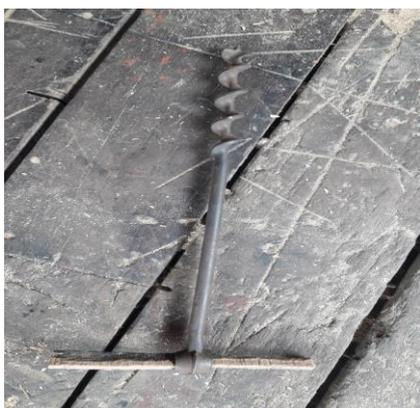
De estrutura metálica (ferro) em forma de espiral, e na parte inferior é pontiaguda, o trado tem aproximadamente 35 a 40 cm de comprimento, preso a um cabo de madeira, confeccionado pelo carpinteiro naval, seu formato permite perfurar madeira para a introdução de parafusos para conectar uma peça da embarcação a outra. Na contemporaneidade este instrumento raramente é utilizado, sendo substituído
