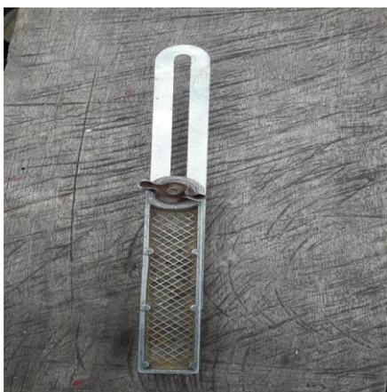
De estrutura idêntica ao esquadro, com cabo de alumínio ou plástico na parte menor. Onde forma o ângulo de 90° graus, possui um pequeno parafuso de rosca com porca em forma de borboletinha, que atravessa de um lado ao outro, permitindo a
