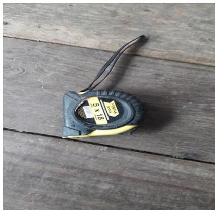
A trena é um instrumento que tem o papel de medir o tamanho das madeiras usadas na embarcação, largura, comprimento e altura do barco, rabeta e rabudo, fazer a marcação da distância de um braço ao outro, assim como das cavernas também etc.
