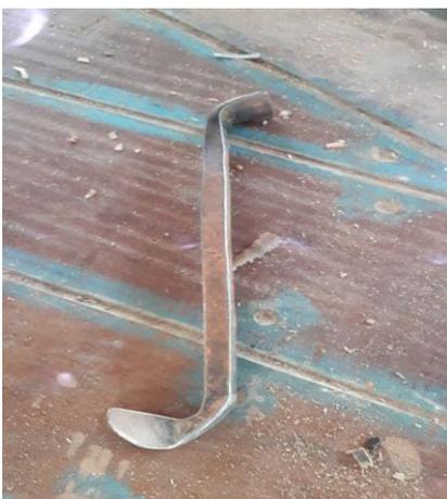
Instrumento de ferro maciço, recurvado e cortante em uma das suas extremidades. Usado para retirar o calafeto velho das embarcações e deixar caminho livre para a introdução de um novo calafeto.
