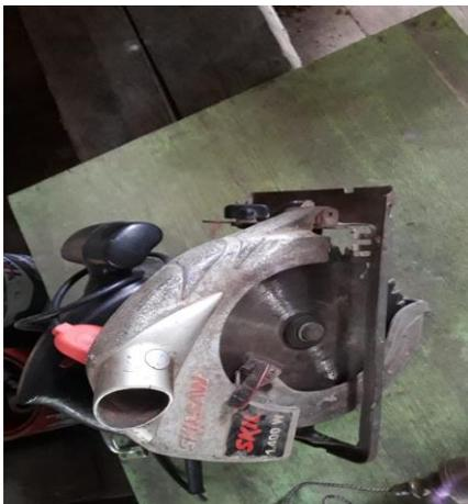
Esta possui um disco cortante, com uma chapa de regulação, serve para cortar tábuas de pequena espessura, fazer talhamento de falcas e fundos das rabetas e rabudos etc. Ela não substitui o serrote, apenas é um complemento dele no processo de construção.
