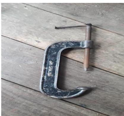
Usados para prender as tábuas quando estas estão em processo de moldagem, preparação das costuras e também no momento da fixação destas junto aos braços e cavernas etc. Com estrutura de ferro, tem o formato de uma letra “C”, onde numa das extremidades de aberturas passa um espiral em forma de parafuso, com ferro, e quando acionado permite a
