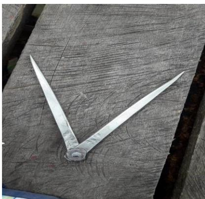
Ferramenta formatada como um “V” quando aberta. “Ele é formado por duas pequenas hastes unidas na parte de cima” (BRAGA, MAGALHÃES, 2011, p. 102). Na construção naval, é usado para medir a largura de tábuas, fazer pontos de marcação nas tábuas, marcar o local de cavaduras nos beques etc.
