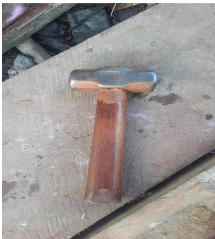
A marreta é um instrumento construído a partir de ferro fundido acoplado a um cabo de madeira, pois sua finalidade na calafetagem é ajudar o calafate na introdução do algodão na embarcação. Usa-se ela juntamente com a palmeta, escariador e carcanel no processo de calafetagem.
