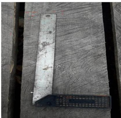
É um instrumento em forma de “L”, a parte menor é revestida de um cabo, podendo ser de plástico ou alumínio. Este instrumento é responsável pela marcação em linha reta das tábuas, para possível serragem etc.
