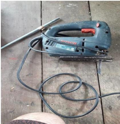
Trata-se de uma pequena serra usada para produzir as pequenas estruturas curvadas de uma embarcação. Seu formato permite preparar pequenas vistas das embarcações, por exemplo. Usada para corte de madeira considerada macia.
