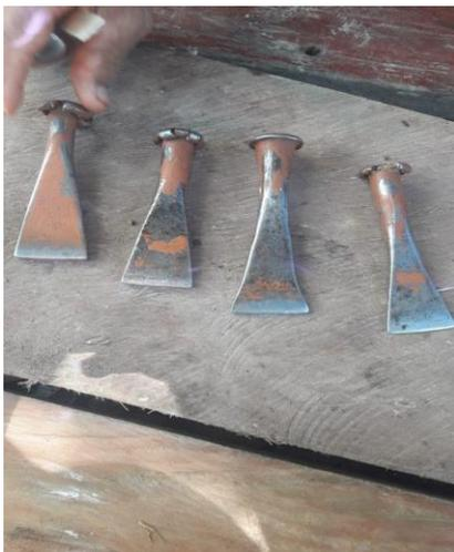
De estrutura em ferro parecido com uma palmeta, o carcanel é um ferro de calafetagem com um ou mais gornes usado para assentar o calafeto da embarcação após a introdução do algodão.
