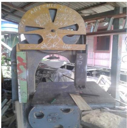
A serra de fita é uma lâmina de ferro com dentes parecidos com o do serrote. Em formato de correia/mofo circular, onde tem uma polia grande na parte superior e uma polia na parte inferior acoplada a um pequeno motor gerador. Este, quando ligado, permite o movimento dela de forma circular. Ela é usada para corte dos braços e cavernas, nas curvas de painel de popa, e outras estruturas parecidas etc.
