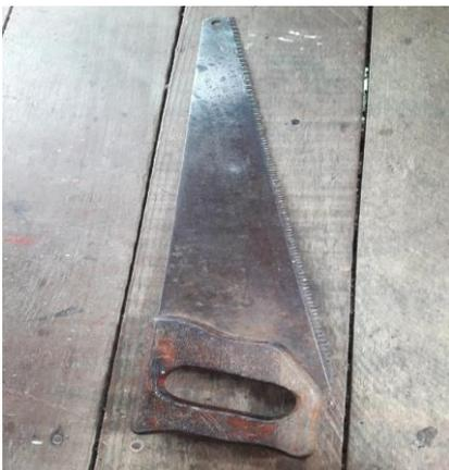
Em formato de uma chapa de ferro fina e com um cabo de madeira com encaixe para a mão, o serrote tem em uma de suas extremidades pequenos dentes, em sentidos contrários, que permitem que ele se torne um instrumento cortante. Na carpintaria naval usa-se para serragem de tábuas, no acabamento de braços e na preparação para assento do alcatrate etc.
