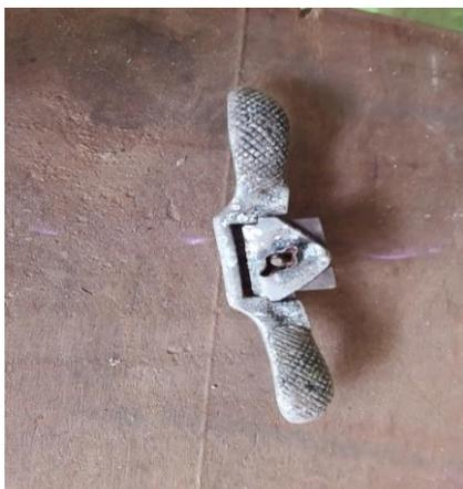
Pequeno instrumento de trabalho do carpinteiro, construído em ferro, possui uma estrutura quase idêntica a um barbeador/prestobarba, com uma lâmina amolada, era responsável para fazer o polimento/acabamento das estruturas das embarcações, retirando as impurezas das madeiras. Substituído hoje pela lixadeira elétrica.
