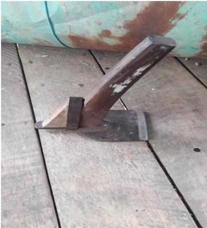
De estrutura composta de chapa cortante e conectada a um cabo de madeira é construída pelo próprio carpinteiro naval. Este instrumento serve para retirada de excesso de madeira para facilitar sua junção à outra estrutura de madeira do barco e/ou rabetas, também usada na preparação dos beques, painel de popa etc.
