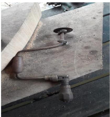
De formato manual, o Arco de Pua, apresenta uma estrutura parecida com a letra “S” (composto por diversas curvaturas em sua estrutura), além disso, possui duas estruturas de madeiras giratórias que permitem o movimento de forma circular, sendo uma arredondada de um lado e na curvatura do meio outra. E uma estrutura em forma de catraca que permite a introdução das brocas (peças furantes). Este
