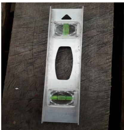
O Nível D'água é um instrumento de alumínio com duas pequenas estruturas de plástico, que formam uma pequena bolha d'água. Quando a bolha ficar centralizada ao meio significa dizer que o que está sendo medido está em um mesmo padrão (idêntico). Serve para fazer, dentre outros, o nivelamento das partes superiores das bordas do barco, por exemplo.
