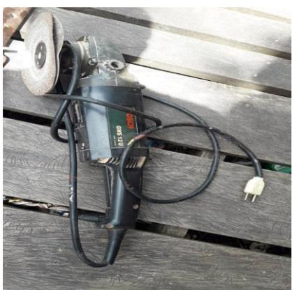
De estrutura em ferro, a lixadeira, é usada para fazer o polimento das cavernas e braços, depois que a embarcação está pronta. É também utilizada para fazer polimento da parte externa do revestimento dos barcos e rabetas.
