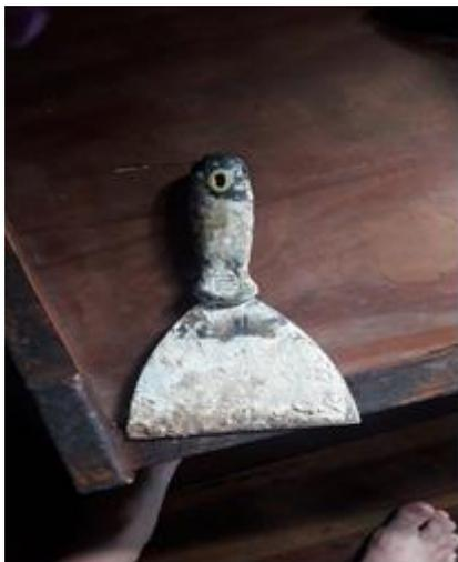
“Uma **espátula** é um utensílio de extremidade larga e plana que é utilizado para mexer e misturar substâncias pastosas. Pode ser fabricado em aço inoxidável, madeira, porcelana e plástico de diversos tamanhos e formas. Amplamente usado em pintura a óleo, para um acabamento mais perfeito das obras, seja sobre tela, madeira, afrescos ou outras superfícies” (EDUCALINGO). No caso dos calafates pintores locais, essa ferramenta é usada, dentre outras, na preparação da massa.
