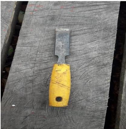
É uma ferramenta de ferro em formato de chapa, possuindo em uma de suas extremidades um cabo revestido em madeira e/ou plástico e, de outro, uma afiada/amolada ponta, que permite ser um objeto cortante. Na construção naval, é responsável em fazer as bueiras das embarcações, os cavados de preparação do beque e do painel de popa etc.
