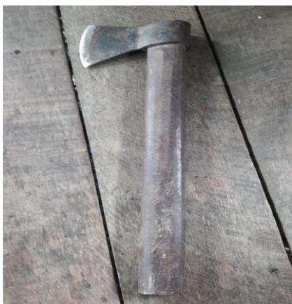
Instrumento muito antigo usado pelos nossos ancestrais, com formato de “lâmina cortante e cabo de madeira, com que se derrubam árvores, racha lenha etc” (BECHARA, 2011, p. 798). Na carpintaria naval local é usado para extrair/retirar os resíduos grosseiros, como por exemplo, o afilamento do beque de um barco, preparação do redondo do barco etc.
