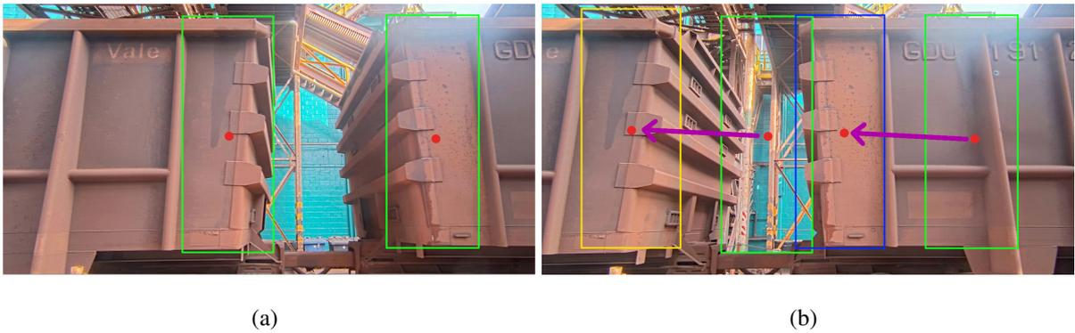
Figura 3.7: Tratamento de oclusão pelo vetor de deslocamento de *elementos visíveis*. Considerando o sentido do movimento dos vagões como sendo da direita para a esquerda, em (a) estão delineados em verde os elementos já rastreados no frame  $F$ . Em (b), no frame  $F + 1$ , o elemento delineado em amarelo não pôde ser encontrado pelo detector, sendo estimado pelo vetor de deslocamento do elemento que foi detectado com sucesso, delineado em azul. Fonte: o autor.
