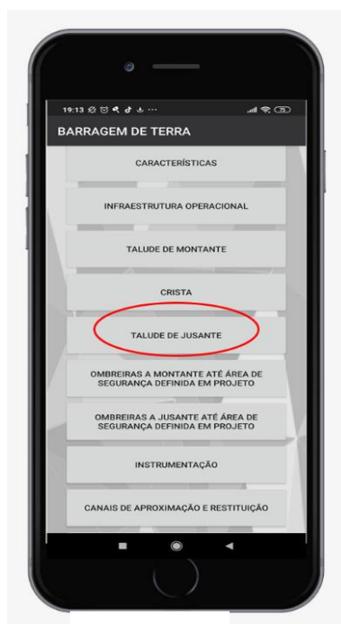
Figura 31-Ficha de inspeção de Barragem de Terra (Talude de Jusante)
