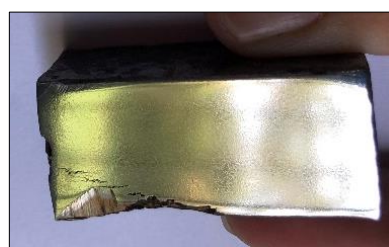
(b) Amostra polida e pronta para o ensaio
