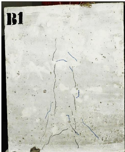
Figura 4.50 - Fissuração do modelo B1
