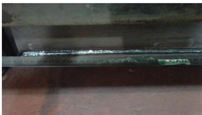
Figura 4.5 – Perfis de um cordão de solda do painel soldado com CW-FCAW utilizando velocidade de soldagem 100 cm/min. Fonte: Autor
