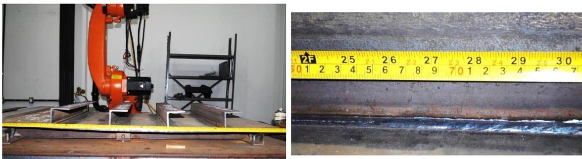
Figura 4.2 – (a) Painel como soldado. (b) Superfície do cordão de solda. Fonte: Autor
