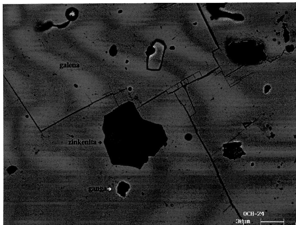
Figura 33 - Galena com inclusão de zinkenita, mineral de ganga e espaços vazios (parte superior direita). Imagem de elétrons retroespalhados no MEV.
