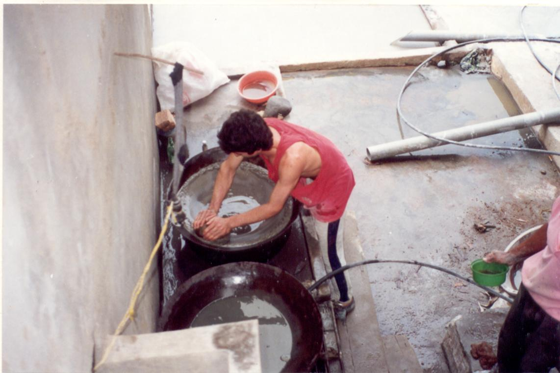
**Figura 8.** Processo de amalgamação manual do ouro-mercúrio do concentrado de bateia no garimpo de Zaruma-Portovelo, Equador.
