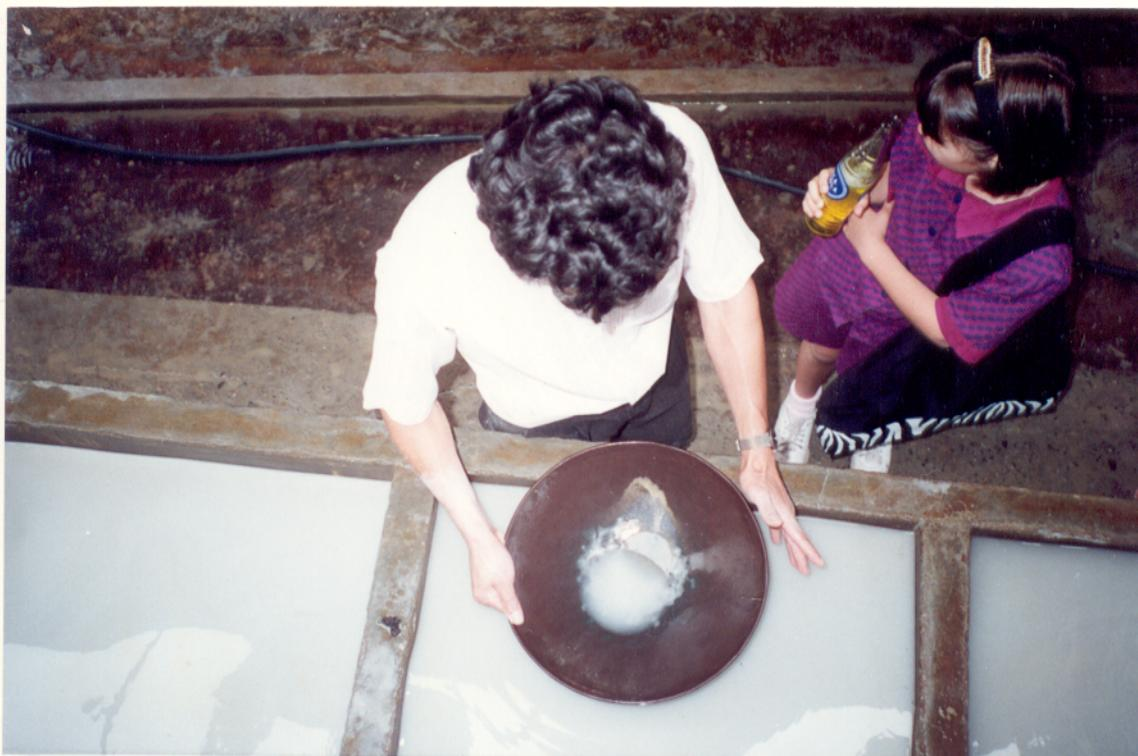
**Figura 6.** Concentração manual, com bateia, do minério no garimpo de ouro de Zaruma-Portovelo, Equador.
