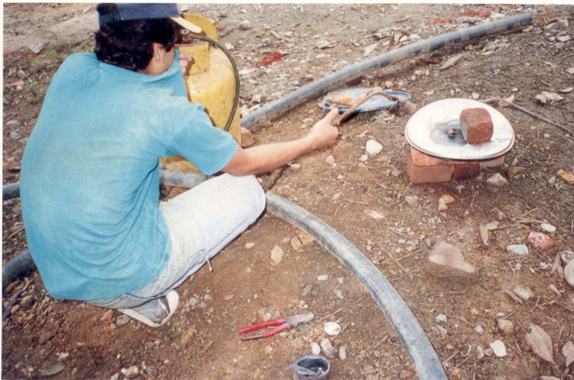
**Figura 7.** Processo de queima com maçarico do amálgama Hg-Au. Ponto de emissão de mercúrio num garimpo de Zaruma-Portovelo, Equador.
