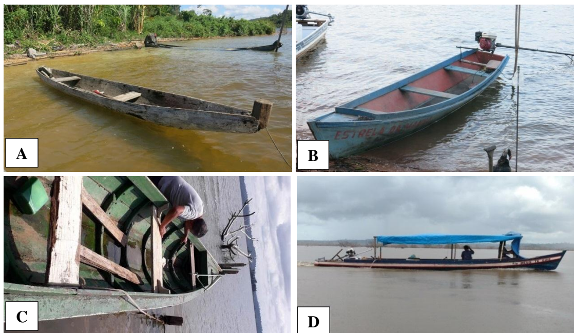
Figura 18 - Modelos de embarcações tradicionais desta região do Xingu: A) Caxiri mais usado para a pesca; B) Barco ou canoa de forma três tábuas; C) Barco ou canoa de forma com caverna; e D) Lancha mais usada para transporte até a cidade.
