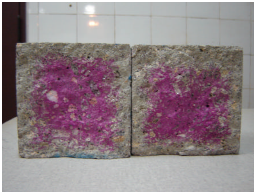
Figura 160. Aspecto da superfície dos corpos-de-prova dos concretos com 10% de RCC90 (à esquerda) e 10% de RCJ85 (à direita), todos com relação água/aglomerante de 0,65, ao final do ensaio de carbonatação acelerada.
