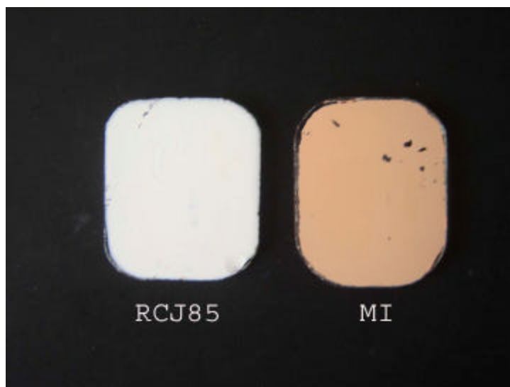
Figura 131. Comparação das cores das pozolanas RCJ85 e MI.
