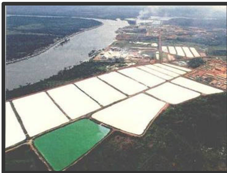
Figura 2. Deposição dos resíduos cauliniticos em lagoas de sedimentação.
