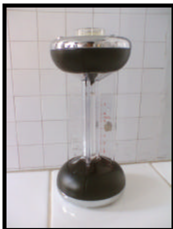
Figura 65 Analisador portátil de gases (CO 2 ) tipo “Fyrite”.
