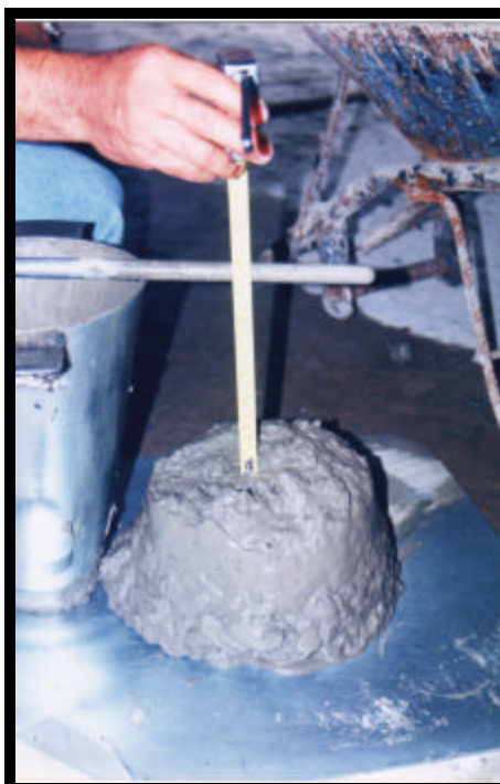
Figura 16. Método para determinação do abatimento de tronco de cone do concreto.
