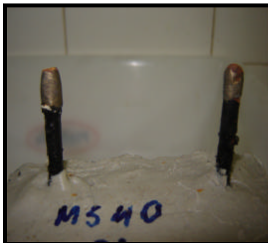
Figura 71. Detalhe da selagem com resina epóxi na superfície do concreto e confecção de cordão de solda e fita isolante nas barras de aço.
