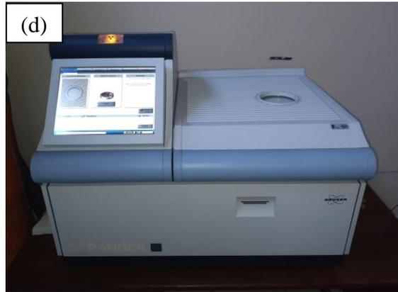
Figura 3.6 – Instrumentos e equipamentos utilizados na fabricação das amostras e determinação da composição química dos resíduos. (a) Molde de alumínio para produção das amostras, (b) prensa hidráulica, (c) amostras de caulim e lama vermelha utilizadas na análise FRX e (d) Equipamento Espectrômetro de fluorescência de raios-X - Marca Bruker- modelo S2 Ranger.
