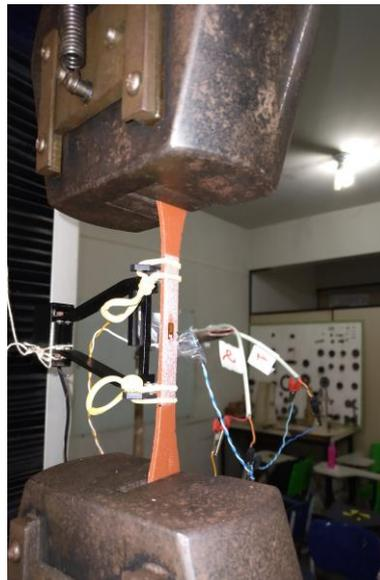
Figura 3.27 - Corpo de prova durante ensaio de tração.
