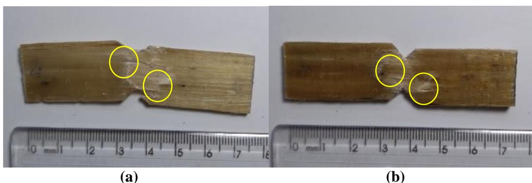
Figura 4.30 – Imagens das amostras, após ensaio de cisalhamento, dos compósitos reforçados com fibras de juta dispostas contínuas e alinhadas a 0°, onde 0J15 (a) e 0J25 (b).
