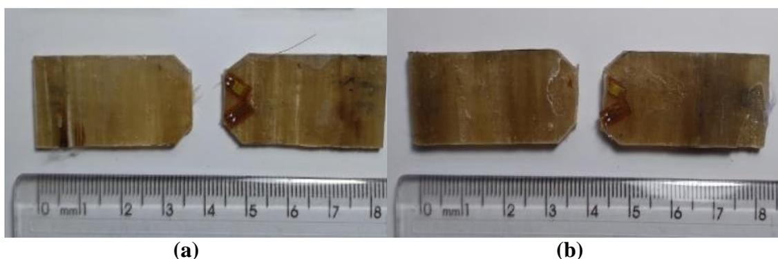
Figura 4.31 – Imagens das amostras, após ensaio de cisalhamento, dos compósitos reforçados com fibras de juta dispostas contínuas e alinhadas a 90°, onde 90J15 (a) e 90J25 (b).
