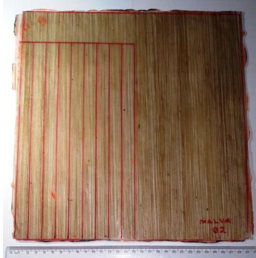
Figura 3.23 – Placa (lâmina) de compósito reforçado com fibras de malva após cura.
