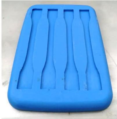
Figura 3.12 - Molde em silicone para moldagem de corpos de prova de tração norma ASTM D 638.
