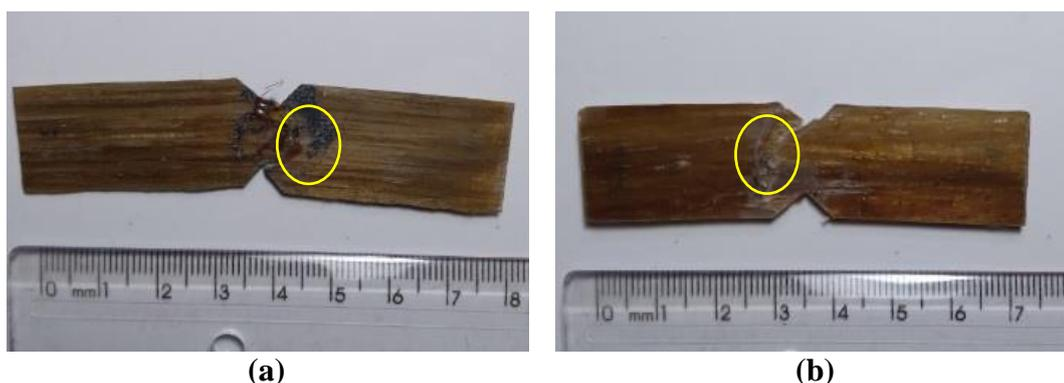
Figura 4.33 – Imagens das amostras, após ensaio de cisalhamento, dos compósitos
