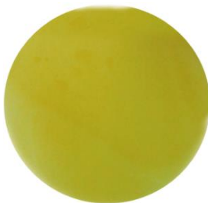
Figura 4. Filme biodegradável, otimizado pela desejabilidade obtido com 2,3% gelatina de peixe, 30% de óleo de buriti e 13,18% de plastificante.
