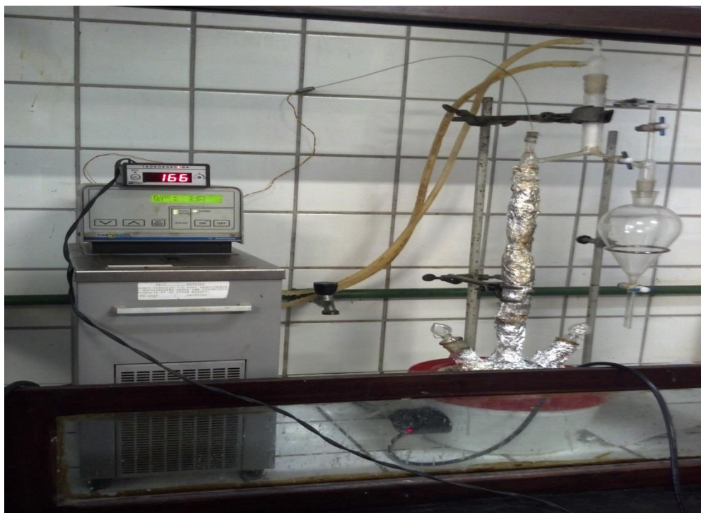
Figura 14 - Aparato experimental de destilação com refluxo. Fonte: Elaborado pelo autor, 2015.
