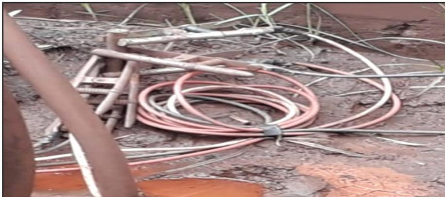
Figura 3.1 - Aterramento de máquina de solda.
