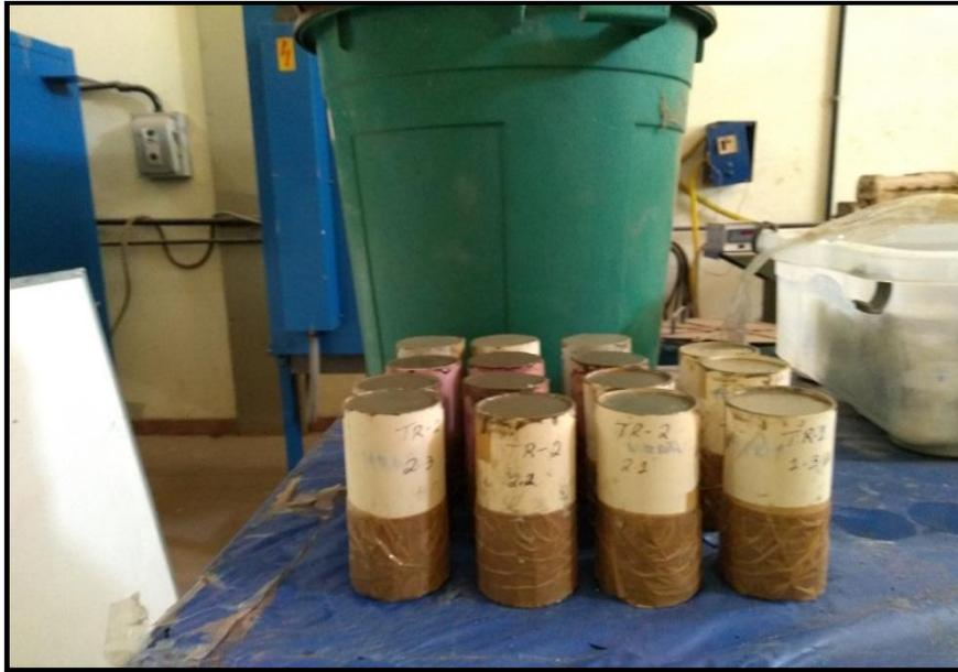
Figura 3.7 - Corpos de prova no molde cilíndrico.
