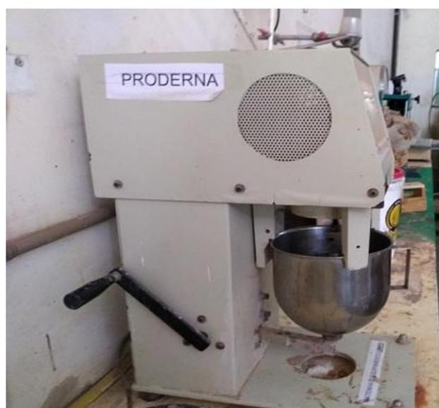
Figura 3.8 - Misturador mecânico SOLDTEST.
