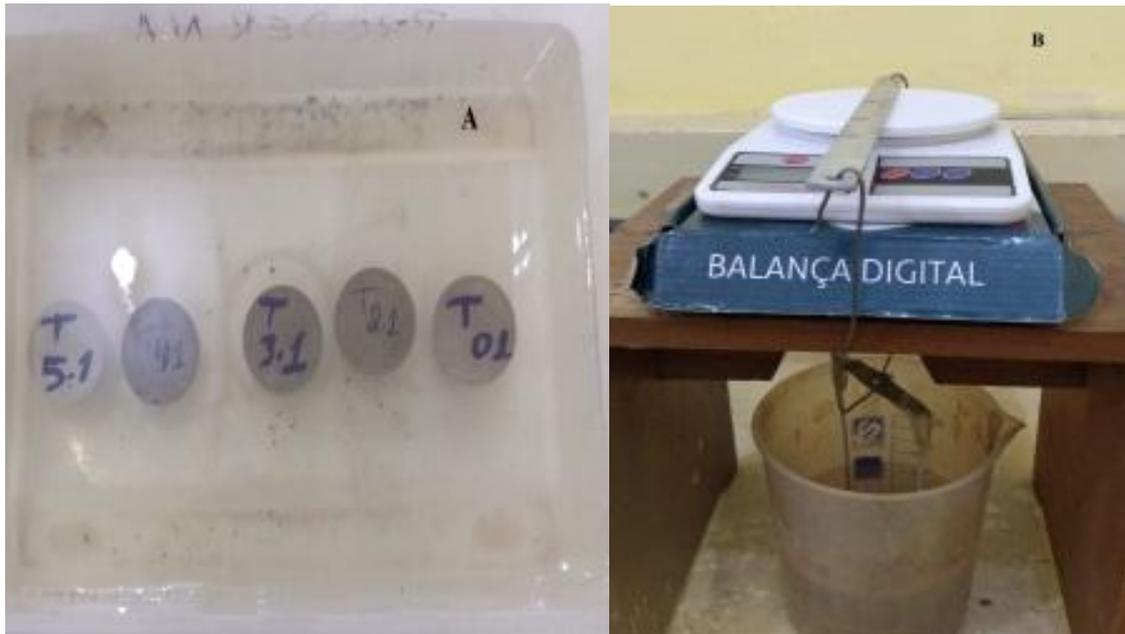
Figura 3.10 - (a) Corpos de prova em imersão por 24Hs e (b). dispositivo para medição da massa imersa dos CP's.
