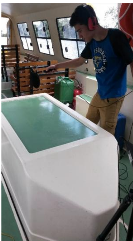
Figura 61 – Medição do nível de Potência Sonora
