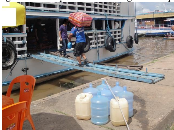
Figura 57 - Rampa de acesso sem guarda corpo.
