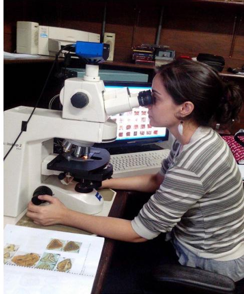
Figura 15- Microscópio Carl Zeiss Axioskop 2 plus com câmera acoplada.
