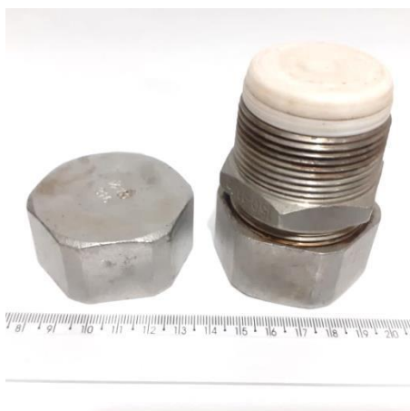
Figura 7. Autoclave de aço com revestimento interno de teflon.
