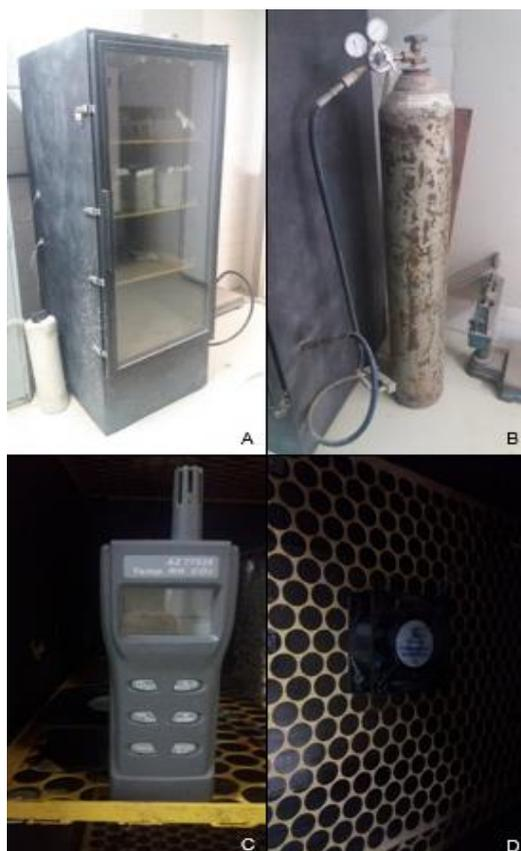
(A) Câmara de carbonatação, (B) cilindro de dióxido de carbono, (C) Leitor de concentração de carbono, (D) Ventoinha. Fonte: Acervo do autor (2019).
