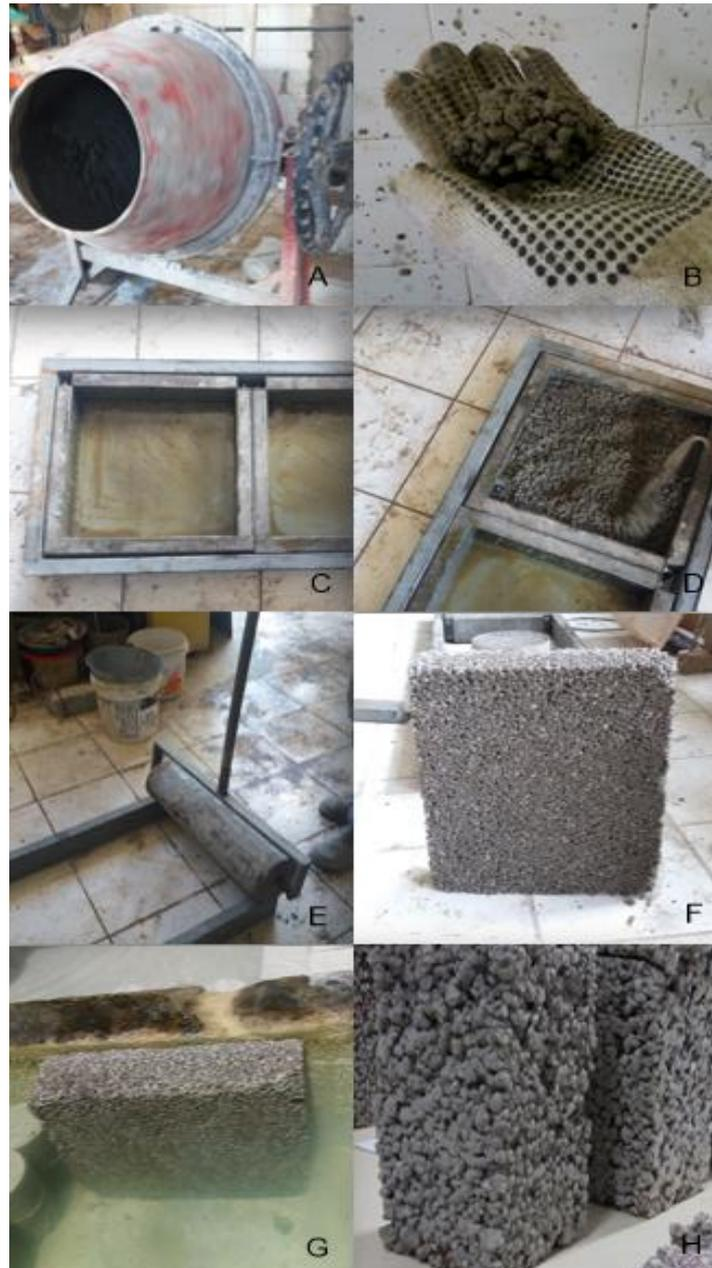
(A) Betoneira de 150 litros, (B) teste visual coesão de Tennis, (C) molde metálico, (D) concreto permeável, (E) rolo metálico para adensamento, (F) desmolde da placa de CPER, (G) Cura e (H) prismas de concreto permeável. Fonte: Acervo do autor (2019).
