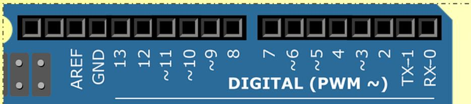
As portas numeradas com o sinal do til, são as portas PWM (Pulse Width Modulation), elas simulam portas analógica, ou seja, emulam um sinal analógico através de pulsos digitais. Podem ser utilizados para diversos controles, como por exemplo o brilho de um LED conectado ao Arduino.
