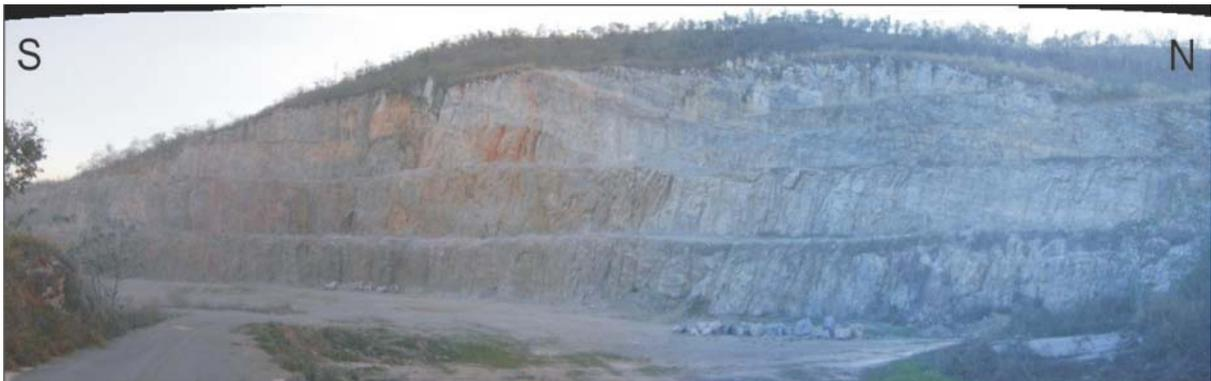
Figura 39- Mina 1, com aproximadamente 300 m de comprimento e 25 m de altura, cuja rocha dominante é o dolomito.
