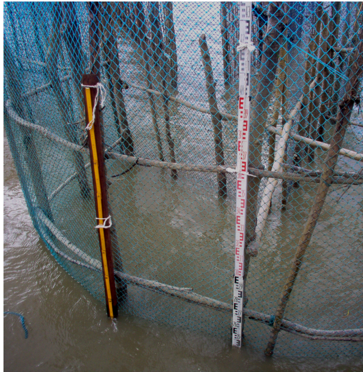
Figura 32: Régua de maré presa em um “curral” de pesca, onde as medidas foram obtidas a cada 20 minutos.
