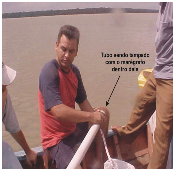
Figura 40: Tubo sendo fechado para evitar contato com a água.
