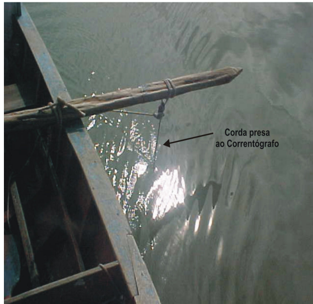
Figura 37: Equipamento preso com um peso de 80 Kg no fundo.
