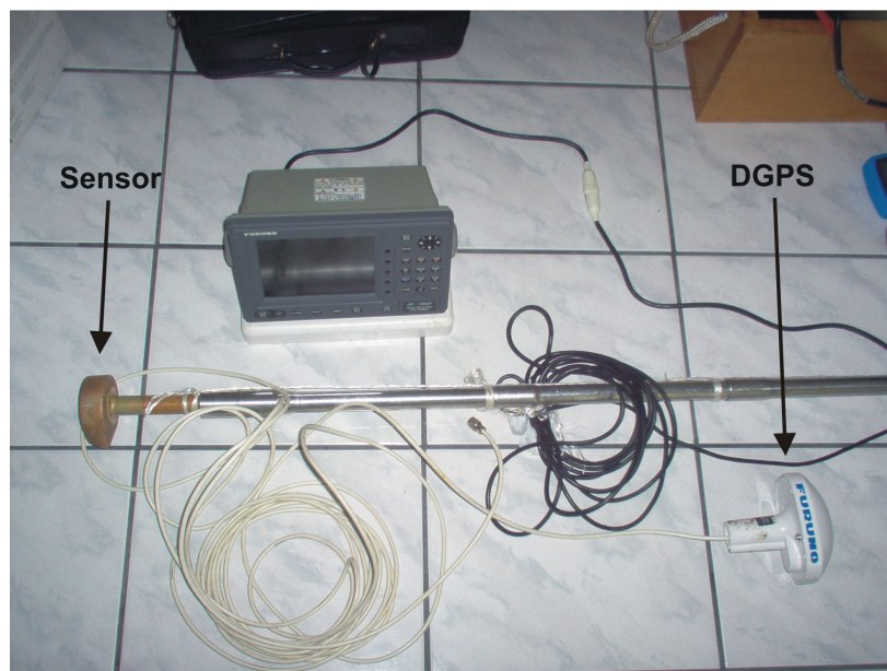
Figura 31: A Ecossonda, o Sensor de recepção dos dados e o DGPS.
