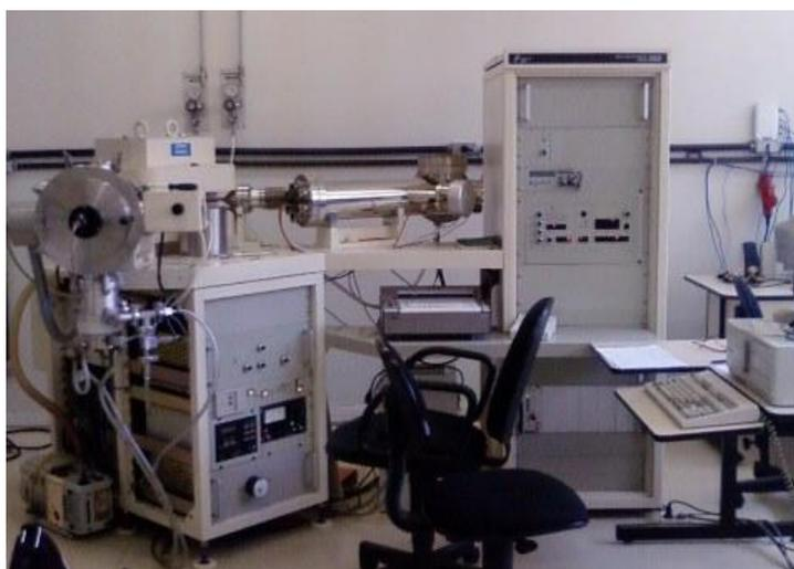
Figura 13: Espectrômetro de Massa de Termoionização - TIMS Modelo Finnigan MAT 262 com multi-coletores do Laboratório Pará-Iso.
