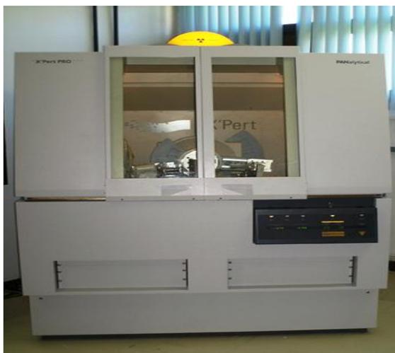
Figura 11: Difratômetro de Raios-X PANalytical PW3040/X0 X' Pert PRO Console do Laboratório de Difração de Raio X do IG/UFPA.
