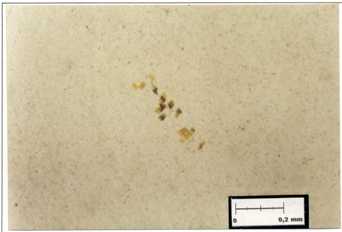
Figura 40 - Fotomicrografia de pequenos cristais de goethita identificados através das propriedades ópticas e difração de raios-X, nas ametistas do Alto Uruguai-RS (nicóis cruzados, 25x).
