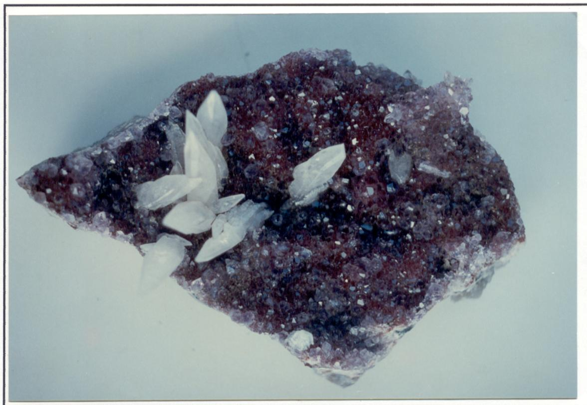
Figura 32 - Segmento de um geodo de ametista com sobreposições de cristais trapezoédricos de calcita (“dente-de-cão”) (Coleção particular do Prof. Marcondes Lima da Costa).
