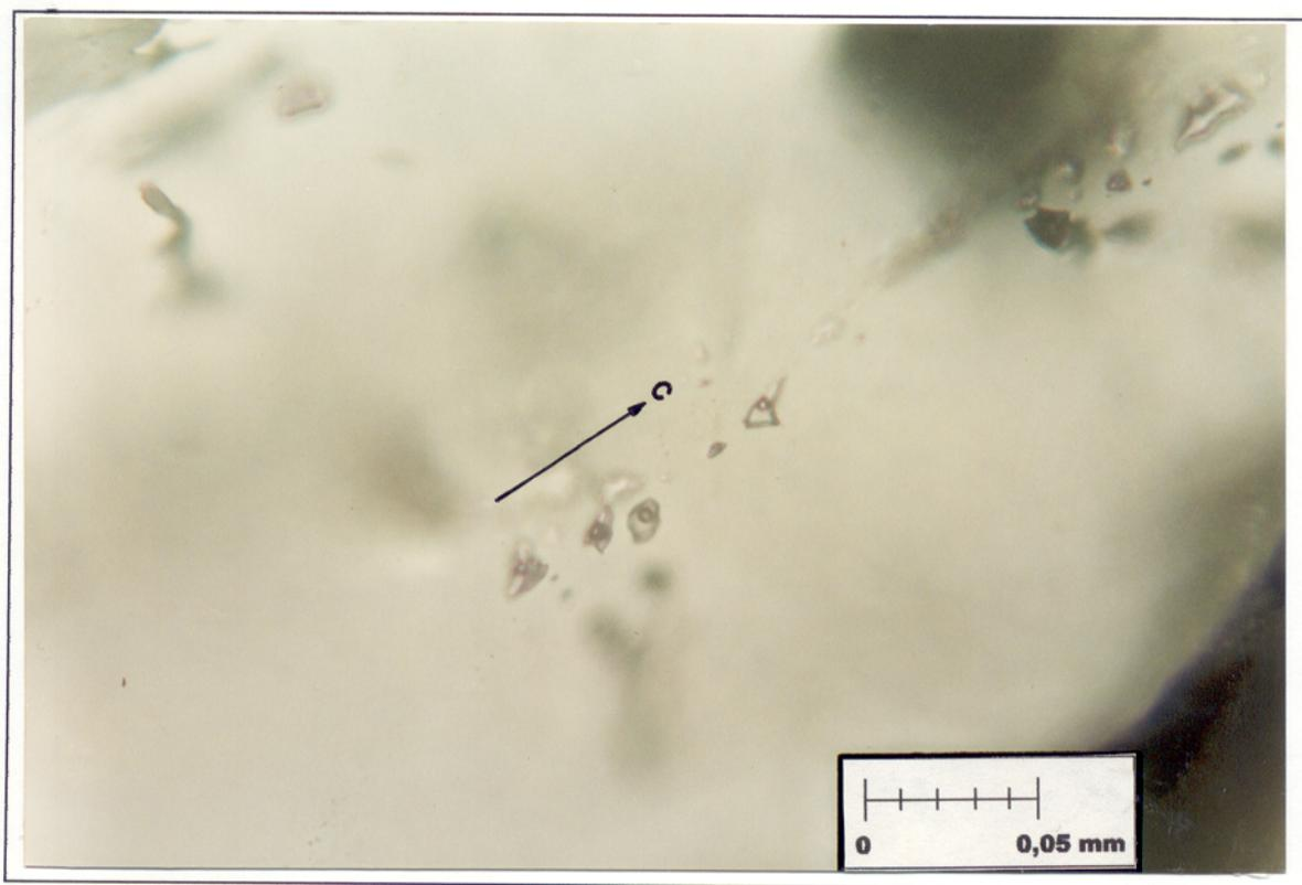
Figura 47 - Fotomicrografia de inclusões fluidas bifásicas primárias (l+g), com formas subarredondadas e irregulares, dispostas ao longo do eixo *c* do cristal de ametista do Alto Uruguai-RS (nicóis paralelos, 40x).
