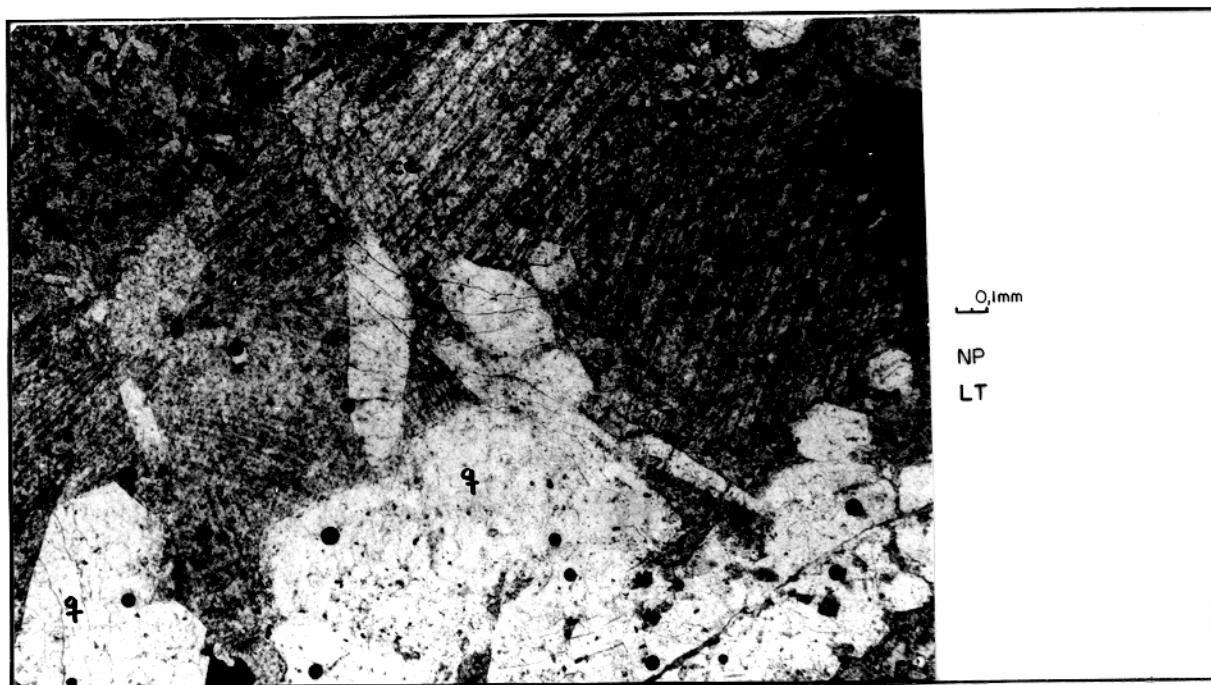
Figura 17 - Fotomicrografia de veio hidrotermal preenchido por quartzo (q), calcita (cc) e calcopirita (opaco), uma das mais freqüentes associações observadas.
