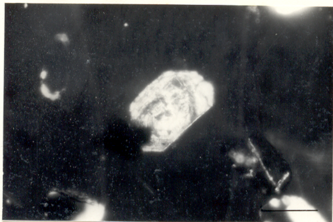
Foto 67 - Grão de zir cão alongado e zonado. Furo AV-06-PA. 76,35m. Nícois X. Obj. 10X. Bar ra=100μm
