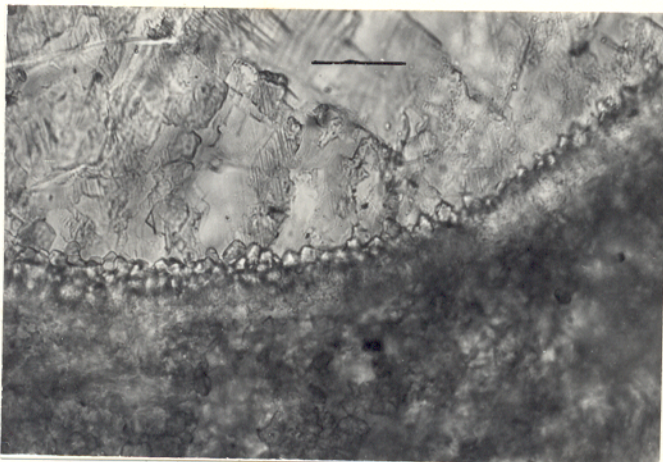
Foto 03 - Cimento "A" serreado na porção in t erna de um ostracode. Furo AV-06-PA. 50,10m. Obj. 25X. Nicóis //. Bar r a=350µm
