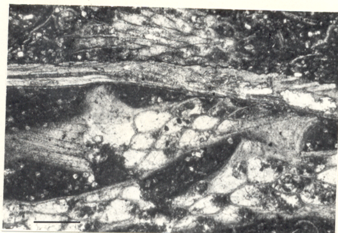
Foto 16 - Diversos fragmentos de briozoários, mostrando as zoécias pre enchidas por calcita espar ítica. Furo AV-06-PA. 59,00m. Nicóis //. Obj. 2,5X. Barra=350µm.
