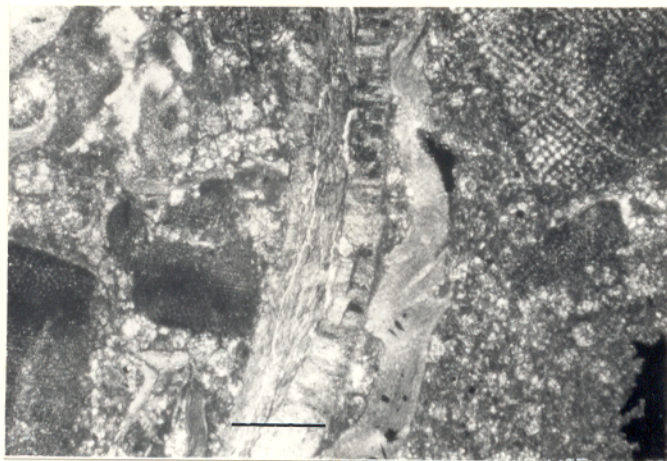
Foto 09 - Fragmento de braquiópode mostrando dois tipos de estru tas, sendo a da esquerda fibrosa e a da direita prismática, separadas por um plano bem delimi tado. Furo AV-06-PA. 73,65m. Nicóis //. Obj. 2,5X. Barra=350µm
