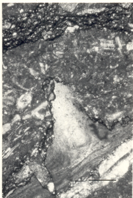
Foto 53 - Estilólito do tipo simples, (em baixo) mostrando o plano de es tilolitização preenchi do por material argilo so, além da contrastante diferença entre o mate rial situado abaixo e acima desse plano. Em ci ma estilólitos interco nectados. Furo AV-06-PA. 59,00m. Nicóis X. Obj. 2,5X. Barra=350µm
