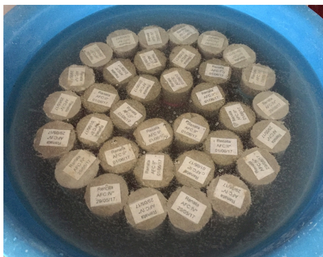
Figura 3.14: Corpos de prova cilíndricos na cura em água. Fonte: AUTORA, 2019.
