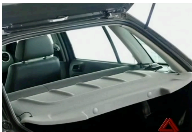
Figura 2.7: Tampa de porta malas produzido com compósitos de curauá. Fonte: PEMATEC, 2017.
