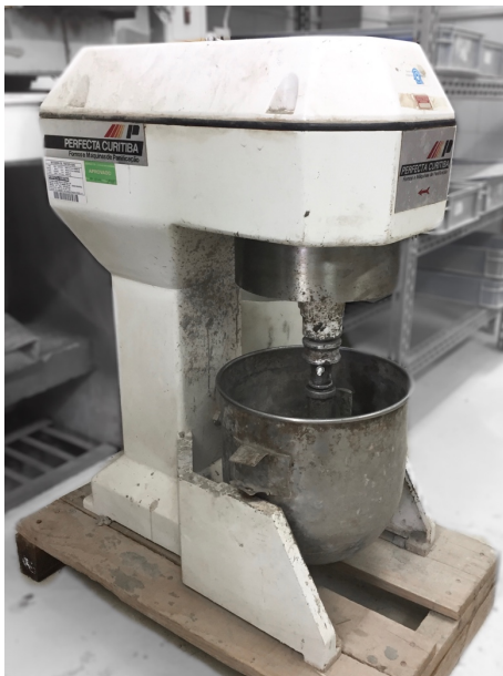
Figura 3.13: Misturador utilizado na produção das argamassas. Fonte: AUTORA, 2019.
