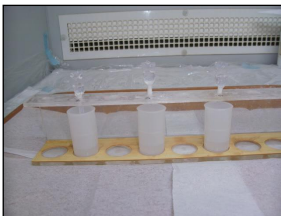
Figura 23 - Colunas de separação cromatográfica de Sr com resina específica (Eichrom®).
