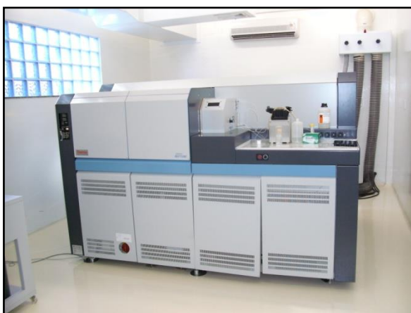
Figura 25 - Espectrômetro de massa com fonte plasma ICP-MS Thermo Finnigan Modelo Neptune do Laboratório Pará-Iso.
