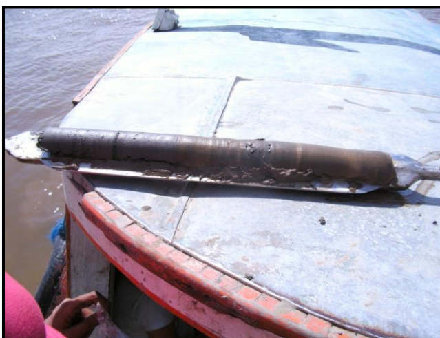
Figura 9 - Coleta de um testemunho de sedimento de fundo na confluência do rio Acará com o rio Carnapijó (amostra B1), utilizando testemunhador tipo Russian Peat Borer .
