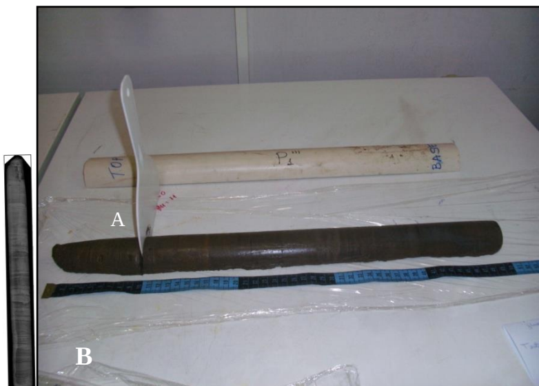
Figura 14 - Radiografia de Raios-X realizada em laboratório médico de um testemunho (amostra B1) da confluência do rio Carnapijó com o rio Acará. (A): radiografia do testemunho e (B): fatiamento do testemunho com pá de plástico.
