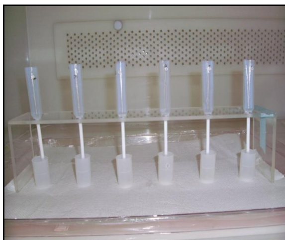
Figura 21 - Colunas de separação cromatográfica de Sm-Nd com resina Ln (Eichrom®).
