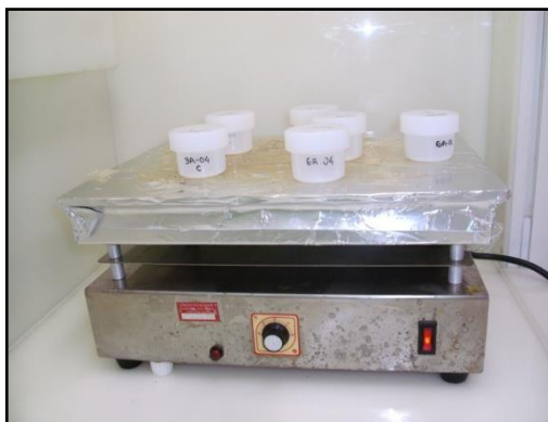
Figura 18 - Dissolução das amostras em chapa aquecedora para a análise de Pb, Sr e Nd.
