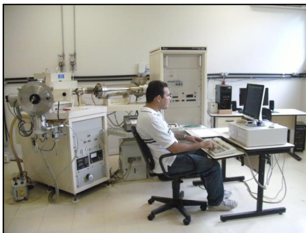
Figura 24 - Espectrômetro de massa de termo-ionização (TIMS) marca Finnigan modelo MAT 262 do Laboratório Pará-Iso.
