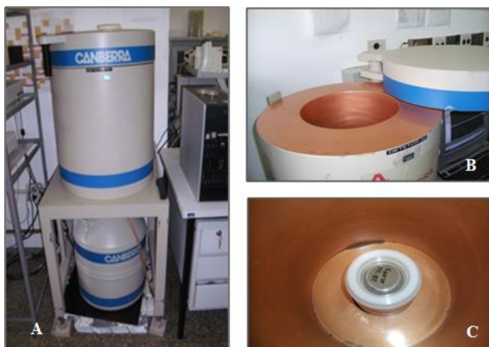
Figura 15 - Equipamento de espectrometria Gama da Marca Canberra HPGE Modelo GX4519, (A) Foto do equipamento, (B e C) Detalhes do compartimento interno onde fica a amostra para análise.
