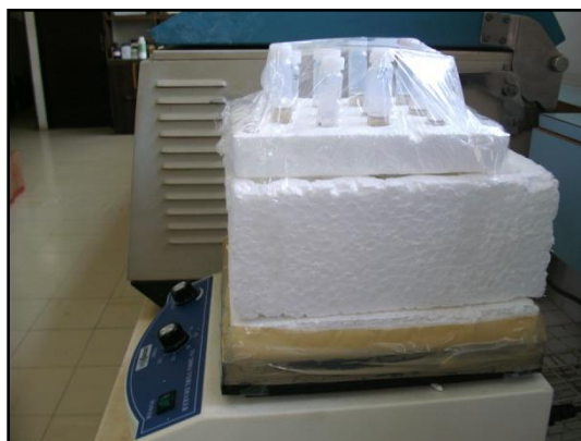
Figura 16 - Etapa de lixiviação das amostras de sedimento de fundo em agitador por 24 horas.
