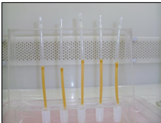
Figura 19 - Colunas de separação cromatográfica dos elementos terras raras (ETR) com resina Biorad Dowex AG 50W-X8.
