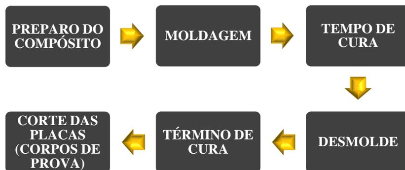
Figura 27 - Síntese do processo de confecção dos corpos de prova.
