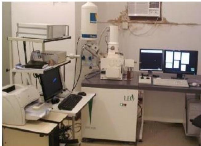
Figura 26 - Máquina de microscopia eletrônica de varredura (MEV).
