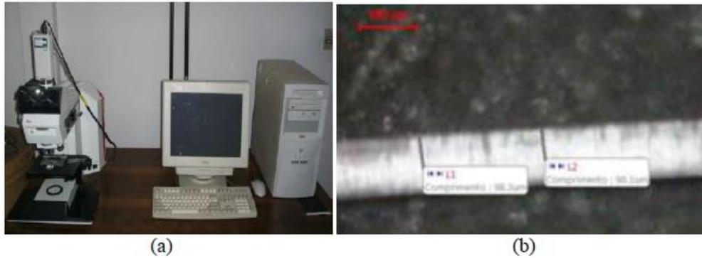
Figura 22 – a) Microscópico óptico, marca LEICA modelo MDR; b) Medição microscópica dos diâmetros das fibras da bananeira.
