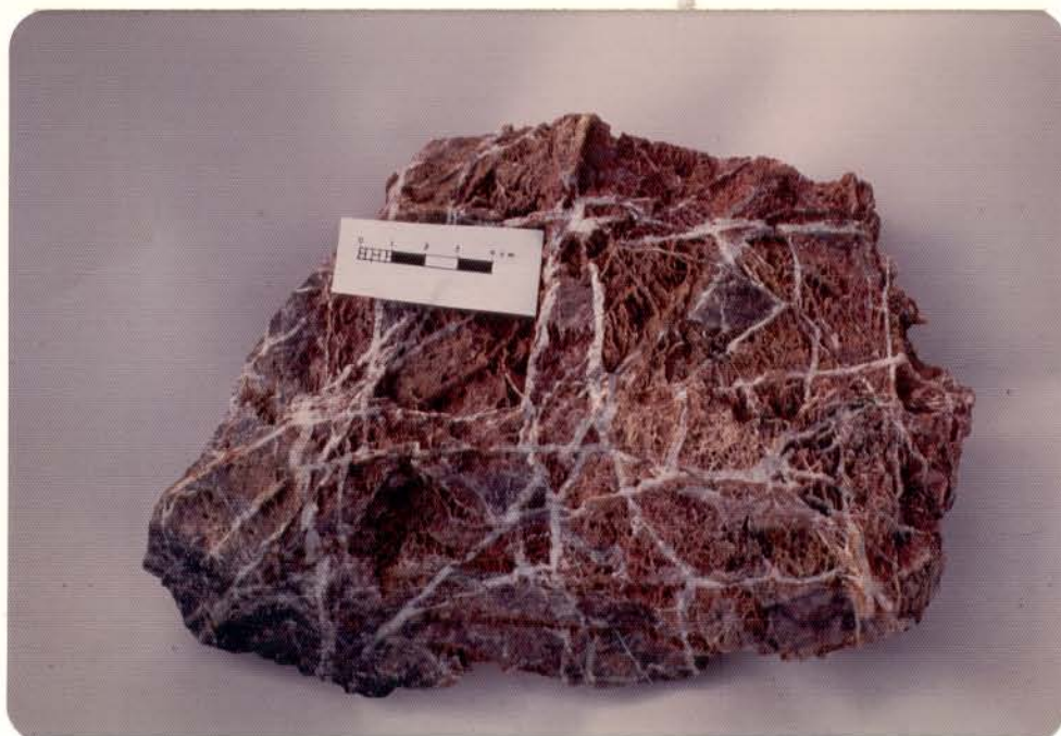
Figura 13 - Venulações irregulares de quartzo intersectando sílexito hematítico ("stockwork"), tipicamente desenvolvidos nas partes superiores dos corpos serpentínicos. Morro do Agostinho.
