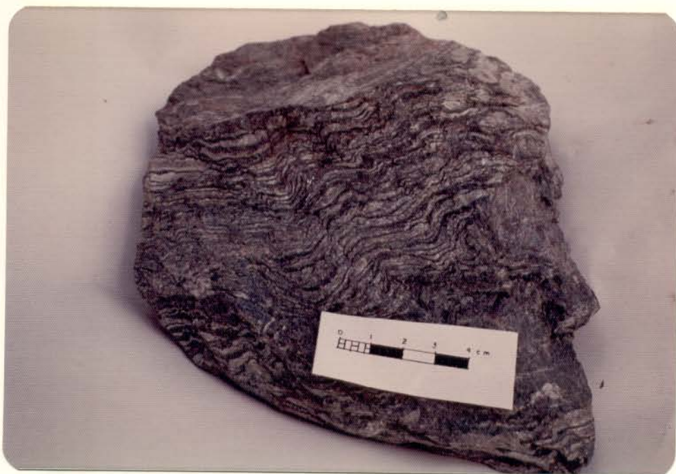
Figura 6 - Bandeamento quartzo-micáceo crenulado, em quartzo-micaxisto da Formação Pequizeiro. PFO-G-100.
