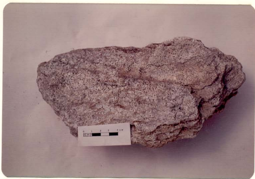
Figura 4 - Aspecto mosqueado característico dos magnetita-moscovita-filitos da Formação Pequizeiro, dado pela presença de cristais de magnetita. Estrada Goianorte-Araguacema, PFO-G-35.
