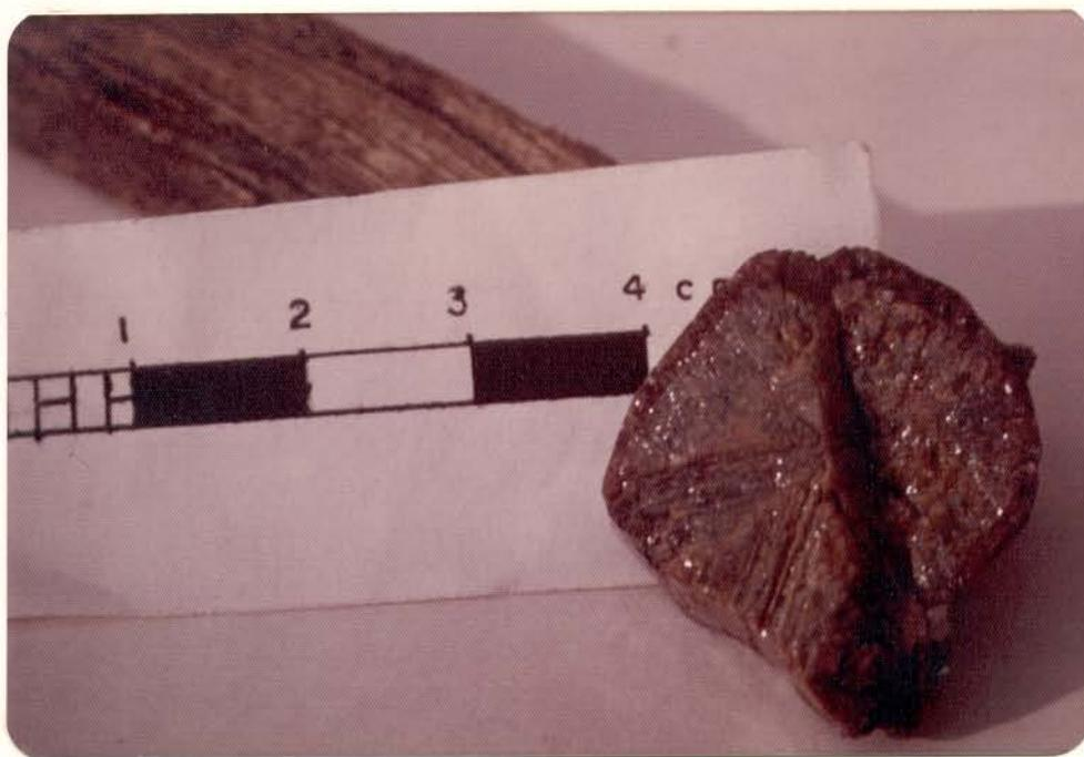
Foto 6.4 - Cristal de zircão mostrando zoneamento interno e fraturamento radial.
